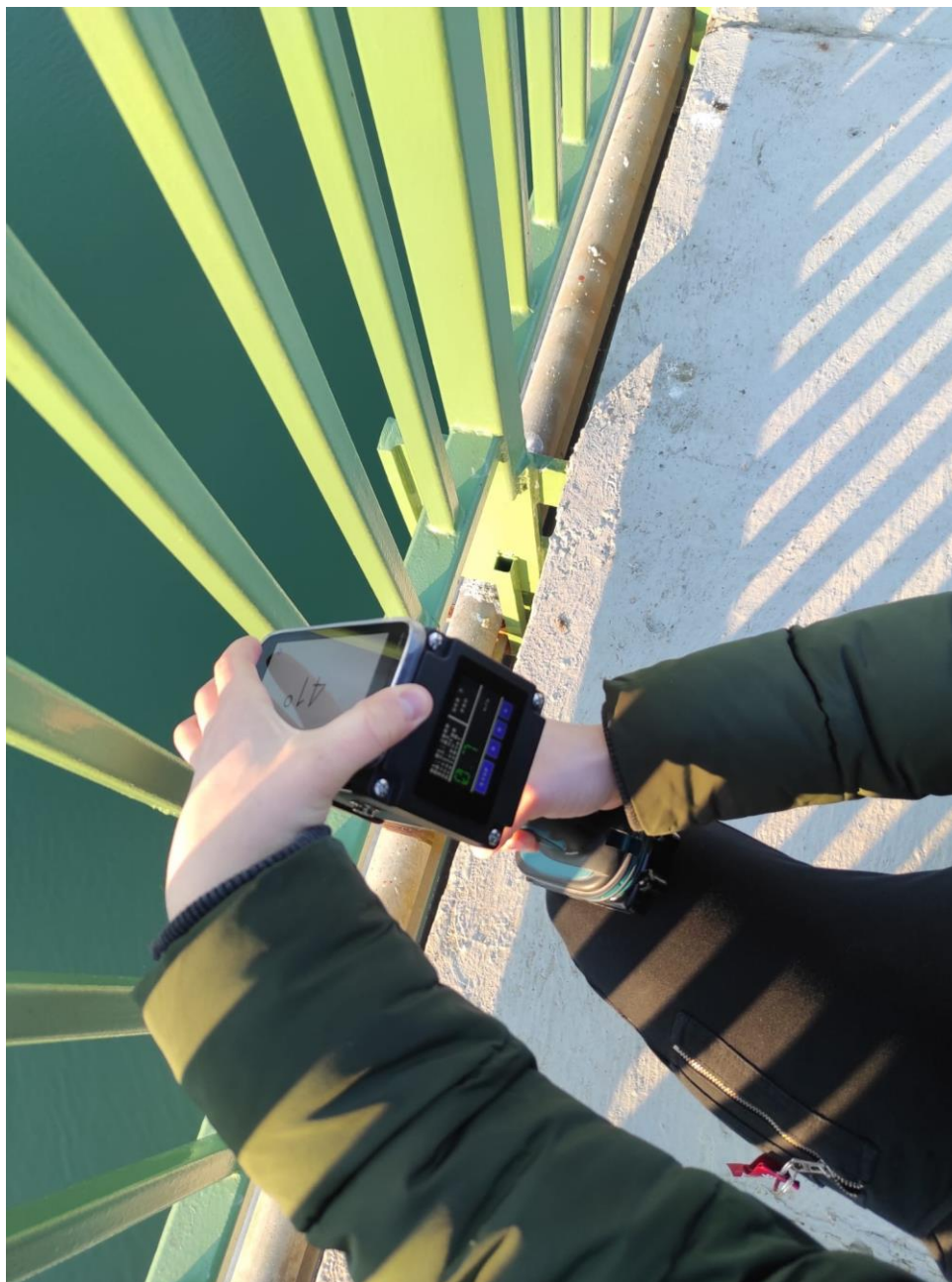
Slika 4.7: Mjerenje površinske brzine fluida radarom
