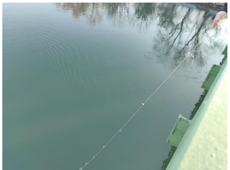
Slika 4.6: Mjerenje dubine: a) bacanje kamena u rijeku; b) spuštanje kamena do dna; c) ostavljanje uža u vodi da upije vodu
