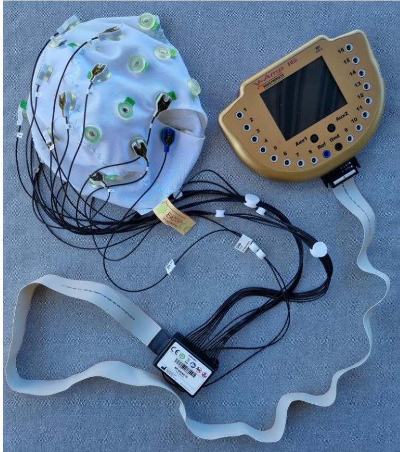
Slika 4.1. Prikaz Brain Products V-Amp akvizicijskog EEG uređaja korištenog u ovom doktorskom radu s 16 aktivnih elektroda pričvršćenih na prilagodljivu Acticap kapu.
