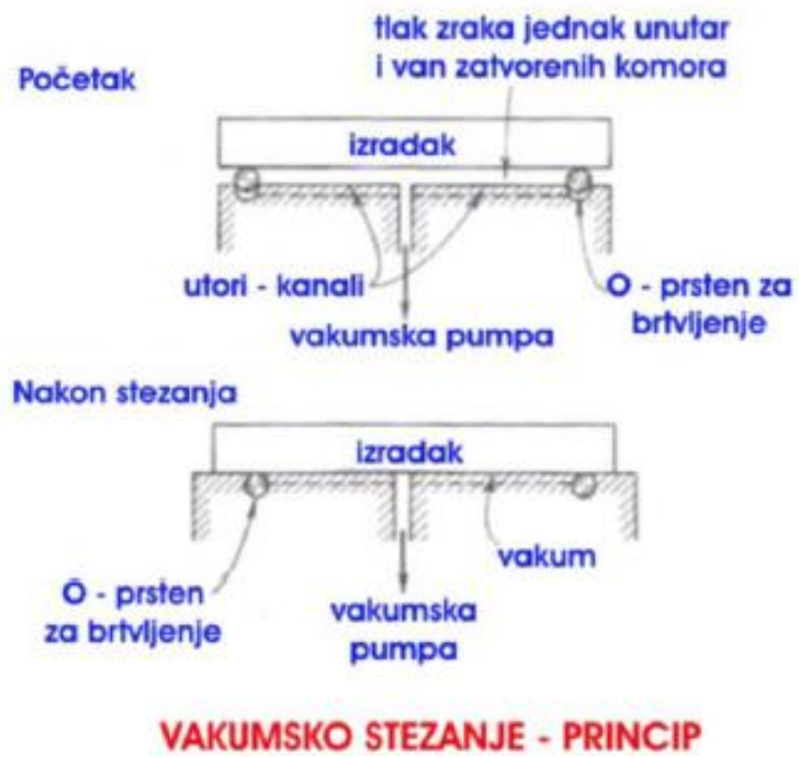
Slika 2.6. – Princip stezanja vakuumske stezne naprave [1]
