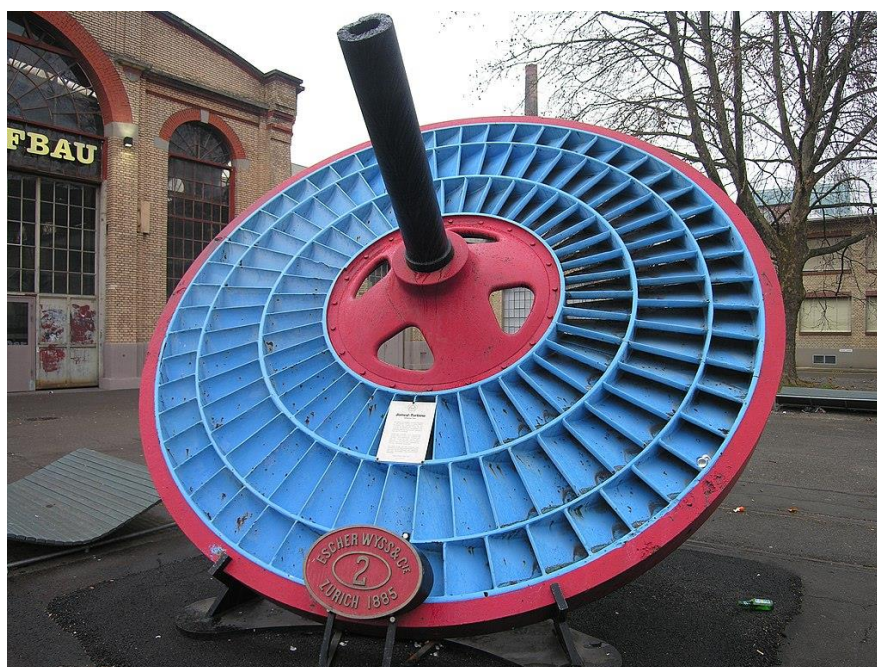
Slika 2.15. Rotor Jonval-ove turbine [21]
