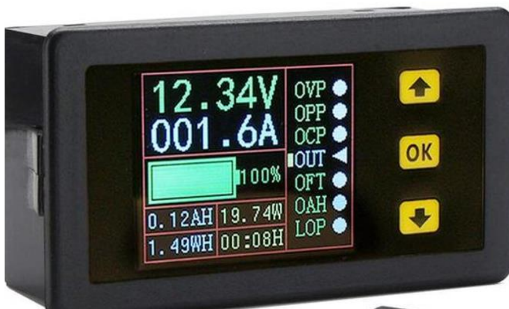
Slika 6.1. Nadzornik baterije za OFF GRID
