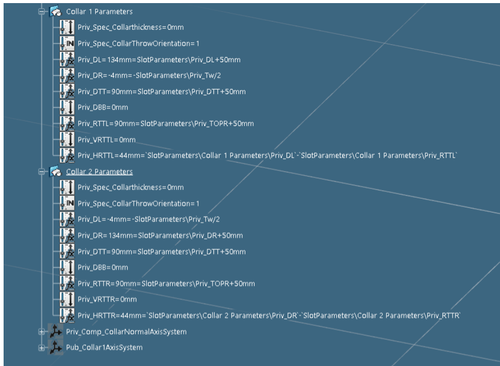
Slika 6.79. Parametri definicije konture generičkog prolaza profila „P22-TB180x8x80x10“, 3.dio
