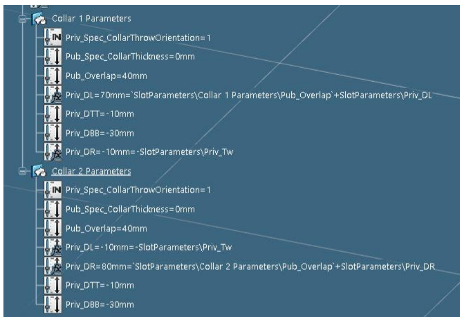
Slika 6.46. Parametri definicije konture generičkog prolaza profila „P12-FB150x10“, 3.dio
