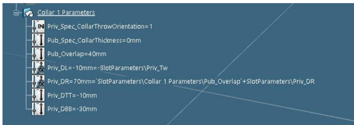
Slika 6.60. Parametri definicije konture generičkog prolaza profila „P15-FB150x10“, 3.dio
