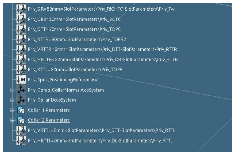
Slika 6.32. Parametri definicije konture generičkog prolaza profila „P7-HP160x8“, 2.dio
