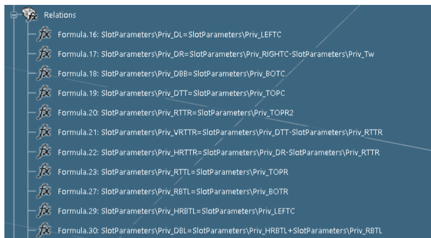
Slika 4.154. Kreirane formule za definiciju parametara unutar „Relations“ radne mape
