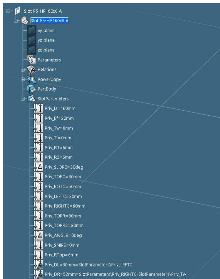
Slika 6.22. Parametri definicije konture generičkog prolaza profila „P5-HP160x8“, 1.dio
