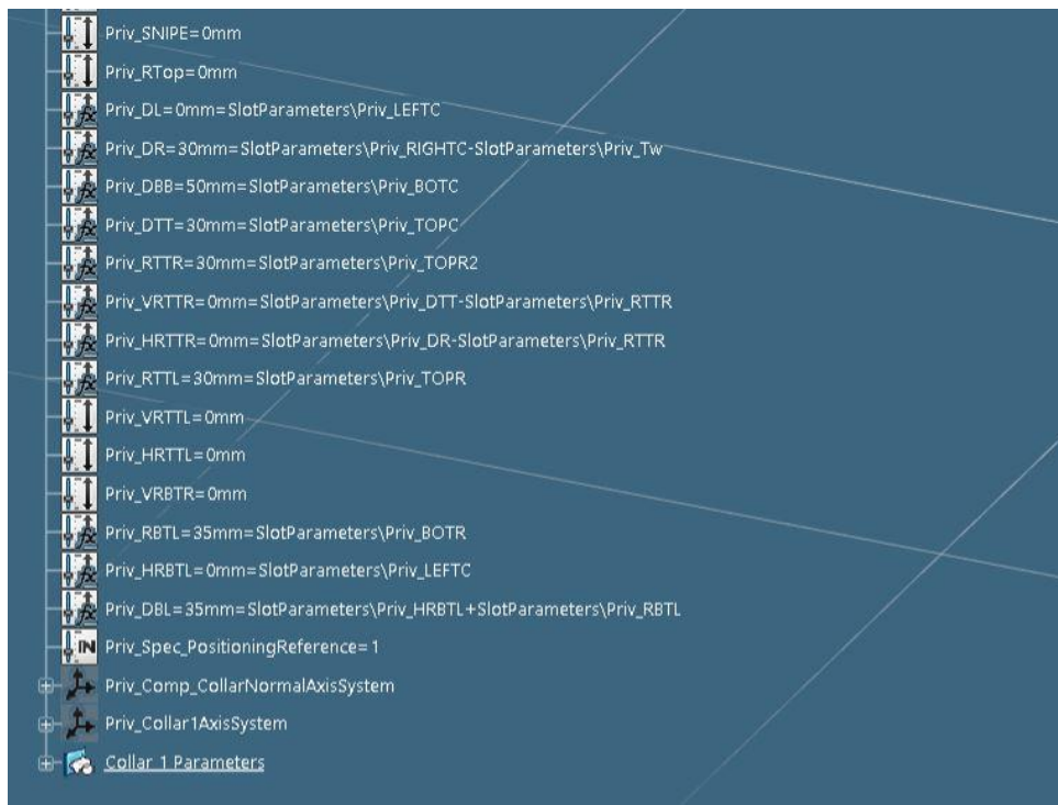
Slika 6.59. Parametri definicije konture generičkog prolaza profila „P15-FB150x10“, 2.dio
