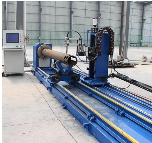
Slika 14. CNC stroj za rezanje prodora
