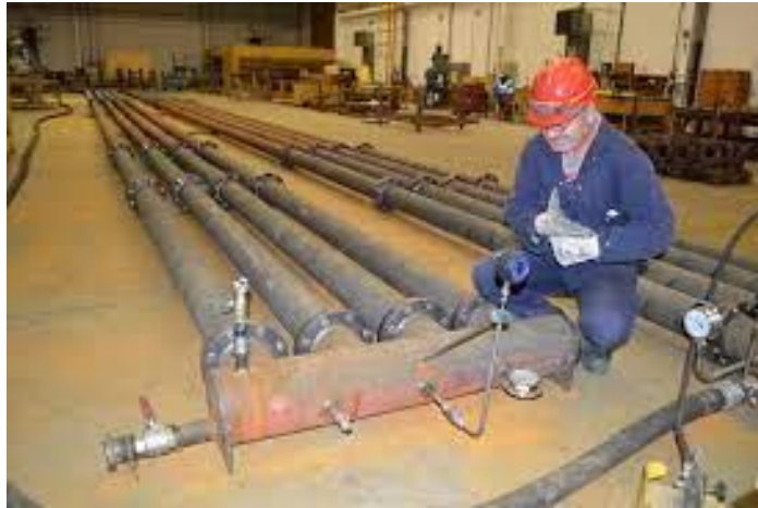
Slika 22. Princip tlačenja cjevovoda u radioni
