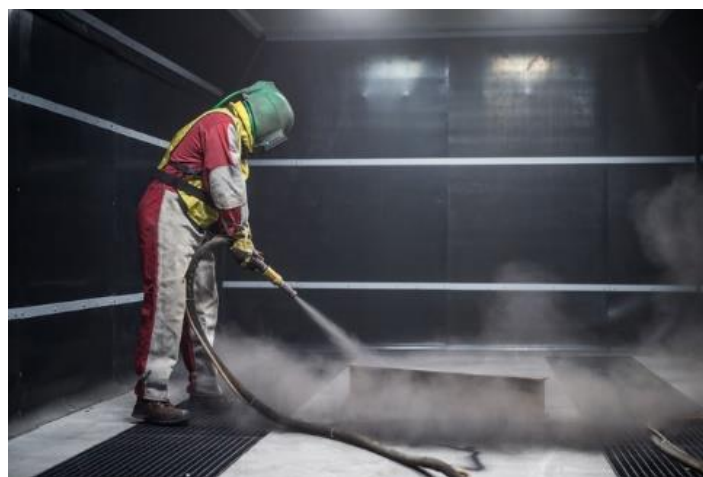
Slika 20. Komora za sačmarenje
