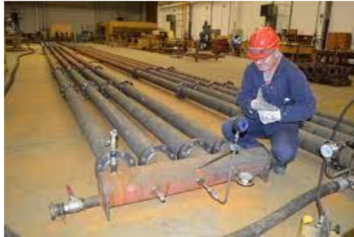
Slika 22. Princip tlačanja cjevovoda u radioni
