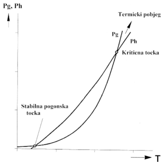
Slika 6.2. Prikaz zagrijavanja i hlađenja metal-oksidnog odvodnika prenapona [1]
