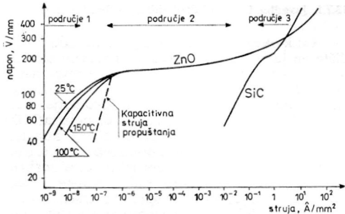
Slika 6.1. Strujno-naponska karakteristika MO odvodnika prenapona [1]
