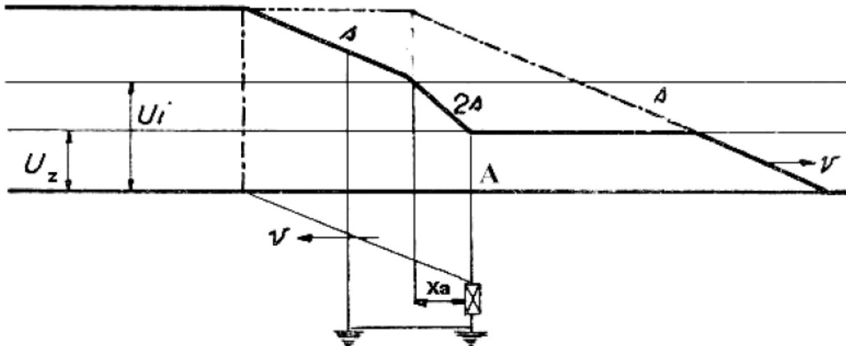
Slika 3.2. Prikaz zaštitne zone odvodnika prenapona [1]
