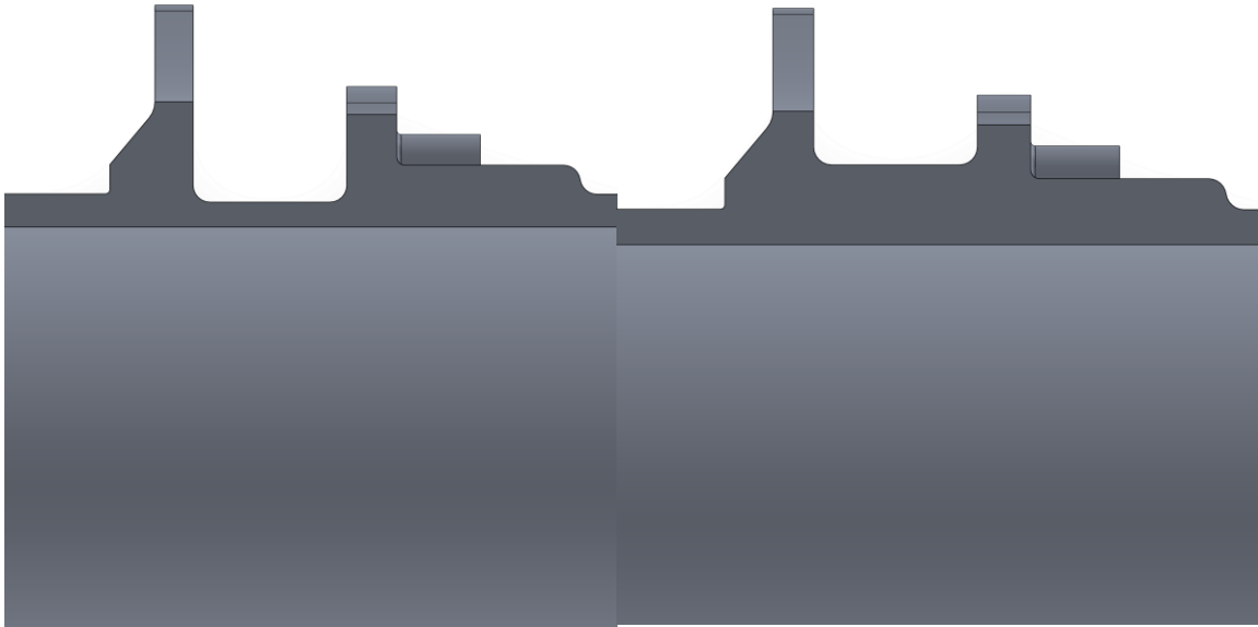
Slika 6.44 Originalni (lijevo) i korigirani presjek glavčine (desno)
