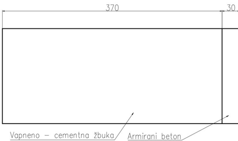
Slika 3.15 Sastav vanjskog zida podrumskog prostora
