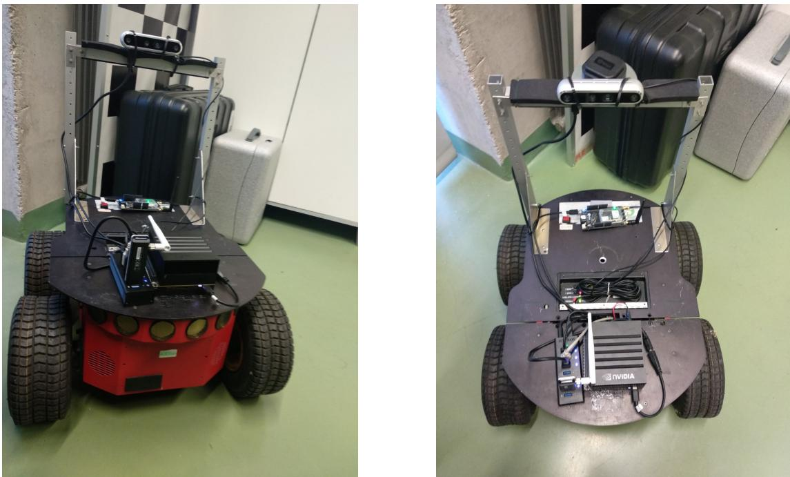
Slika 6.1 Pioneer 3-AT mobilni robot sa korištenim senzorima
