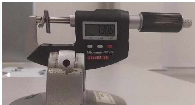
Slika 5.8 Mjerenje predmeta 1 s digitalnim mikrometarskim mjerilom
