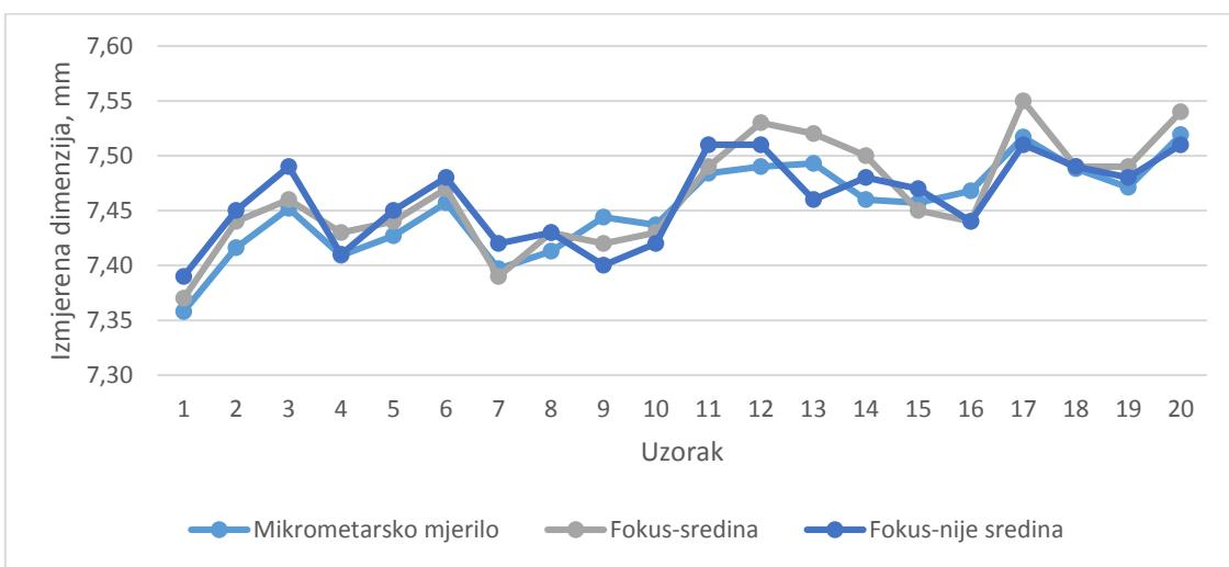
Slika 5.7 Izmjere dobivene promjenom fokusa na RMS-u i izmjera na mikrometarskom mjerilu
