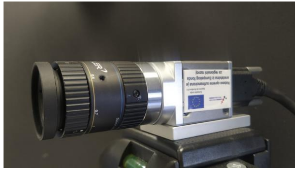
Slika 3.22 Spojeni sustav senzora i objektivu 50 mm
