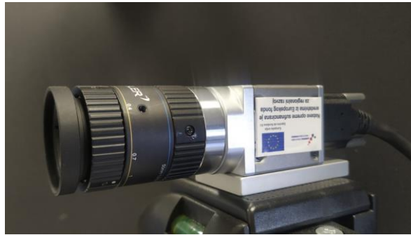
Slika 3.22 Spojeni sustav senzora i objektiva 50 mm
