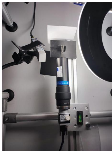
*Slika 5.3 Postavke kamere i osvjetljenja na postavljeni RMS*
