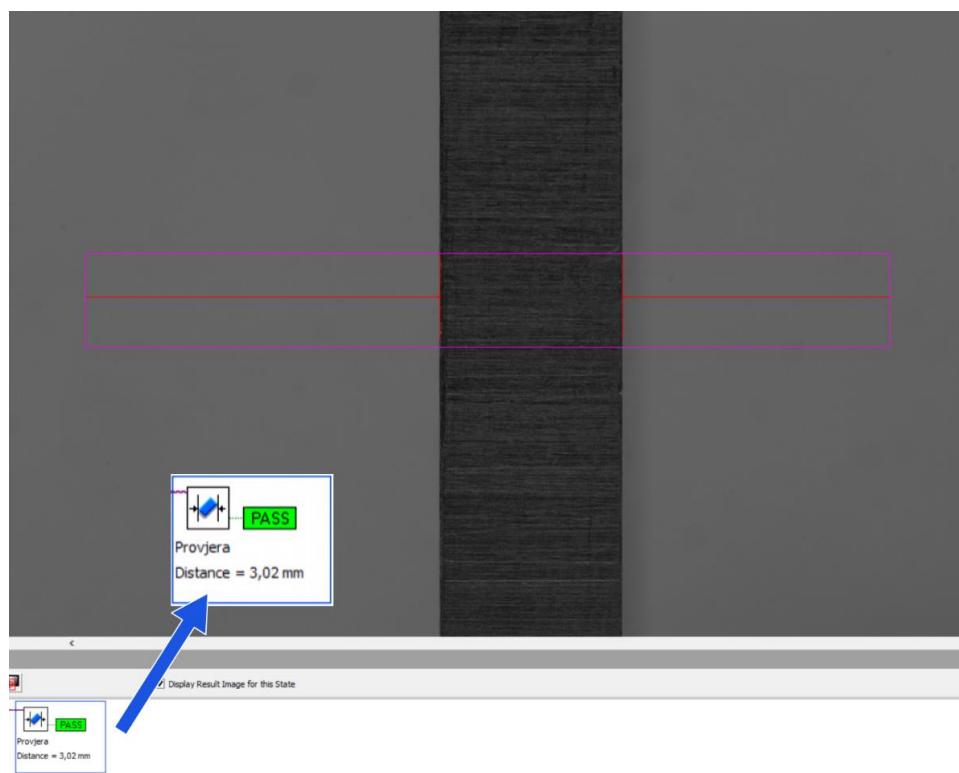
Slika 4.15 Provjera duljine planparalelne granične mjerke duljine 3,00 mm
