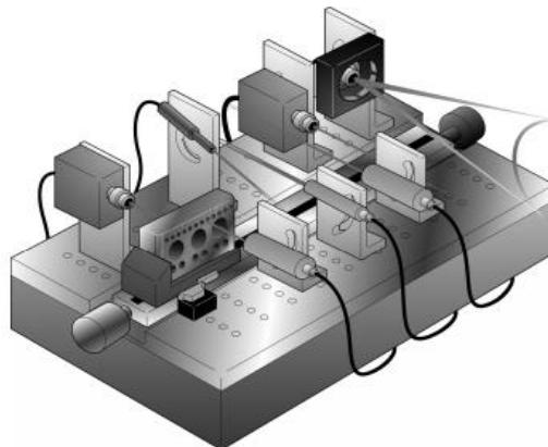
Slika 2.9 Model rekonfigurabilnog inspekcijskog stroja (Koren, 2010)
