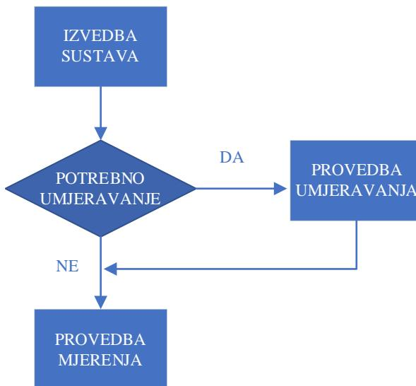
Slika 4.1 Tok postupka mjerena i umjeravanja RMS-a
