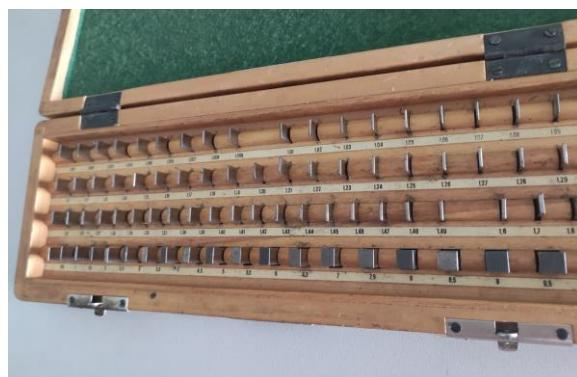
*Slika 4.5 Set planparalelnih graničnih mjerki*
