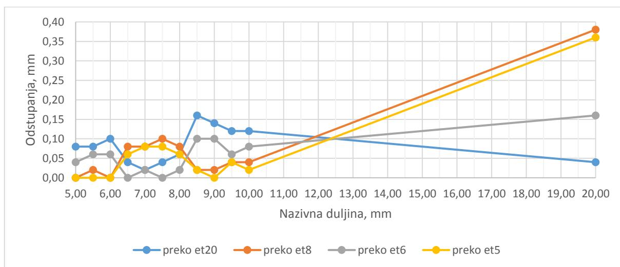
Slika 4.6 Prikaz utvrđenog odstupanja mjerena korištenjem različitih veličina etalona
