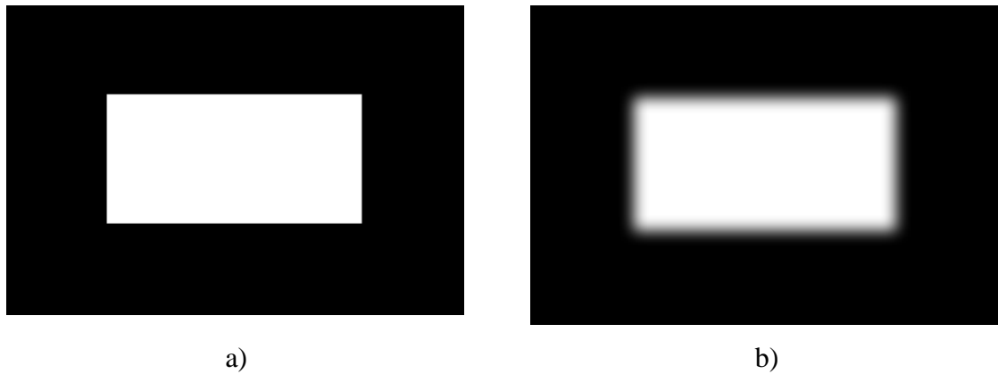
Slika 3.34 Umjetno stvorena slika koja predstavlja: a) idealni predmet slikan na crnoj podlozi i b) realniji prikaz predmeta na crnoj podlozi
