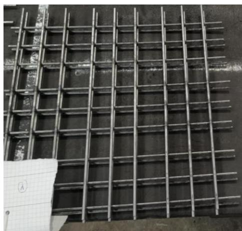
*Slika 5.1 Grupa 1, žice različitih promjera spojene elektrootpornim zavarivanjem*
