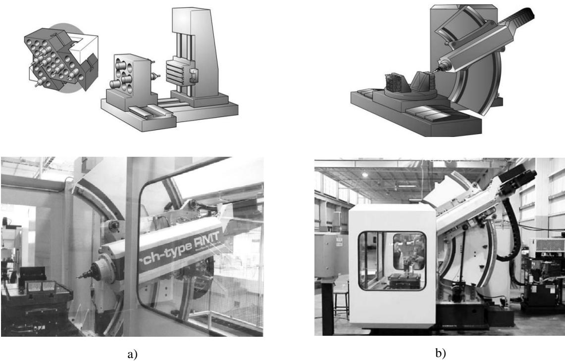
*Slika 2.3 a) Primjeri modela i prototipa rekonfigurabilnih alatnih strojeva za promjenu kapaciteta b) Primjeri modela i prototipa rekonfigurabilnih alatnih strojeva za promjenu funkcionalnosti (Dashchenko, 2006)*
