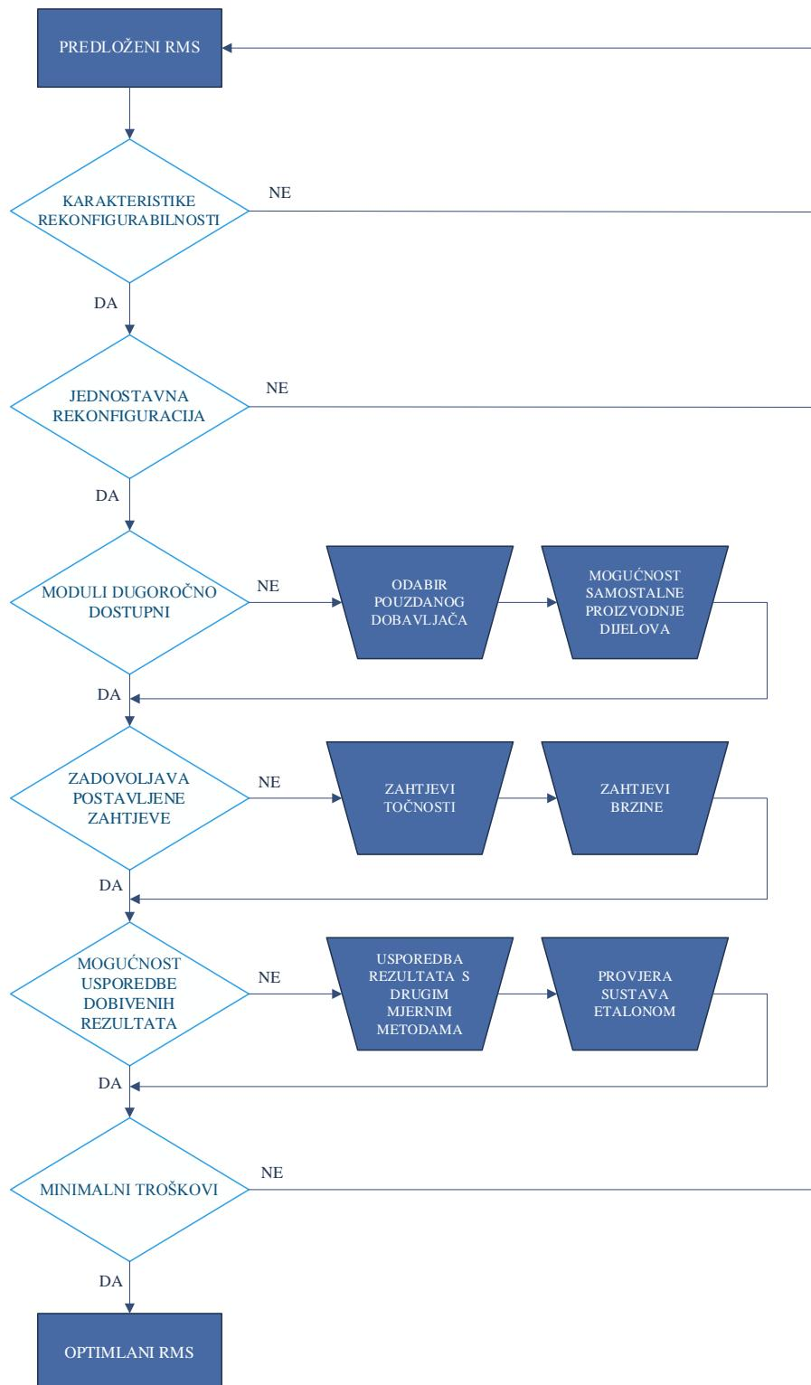
Slika 3.10 Tok postupka projektiranja optimalnog rekonfigurabilnog sustava
