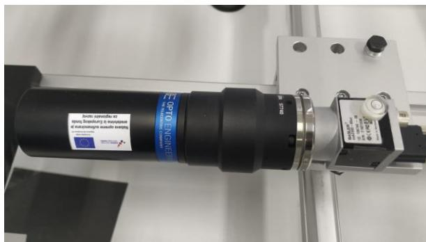
Slika 3.23 Spojeni sustav senzora i telecentričnog objektiva
