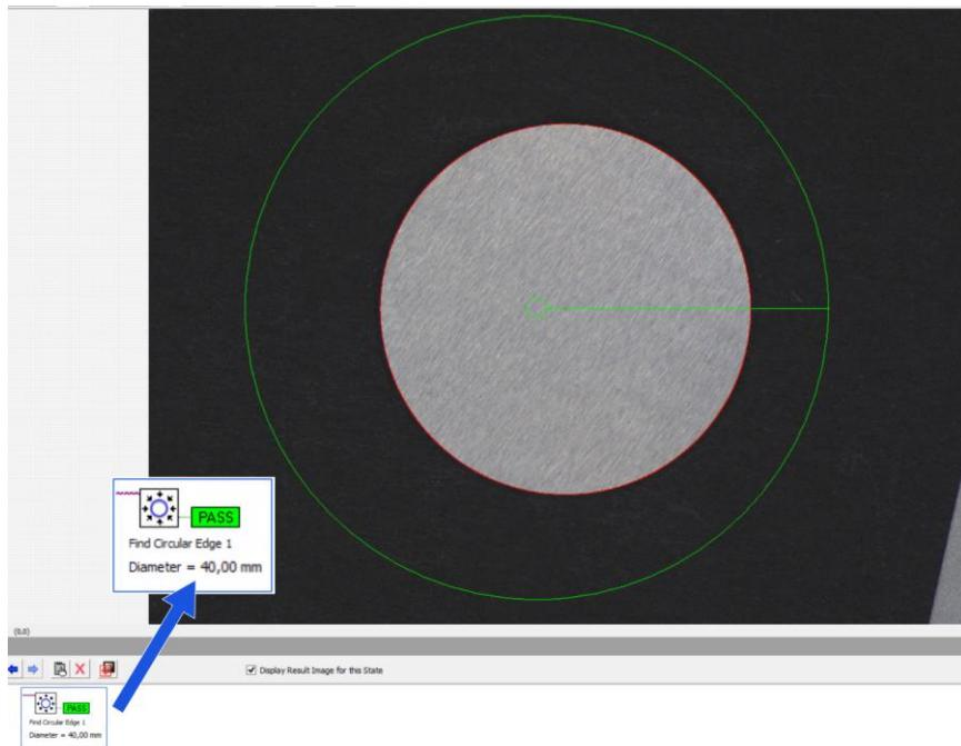
Slika 4.9 Primjer prikaza dimenzije promjera izmjereno predmeta
