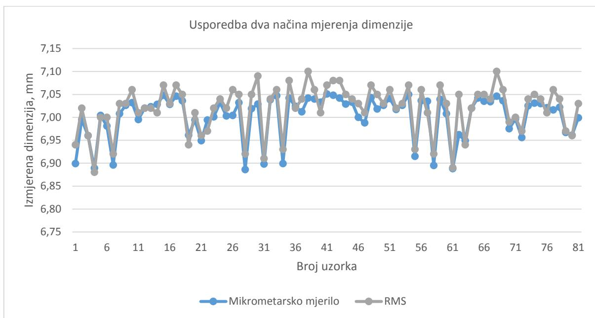
*Slika 5.15 Usporedba rezultata mjerjenja mikrometarskim mjerilom i RMS-om*
