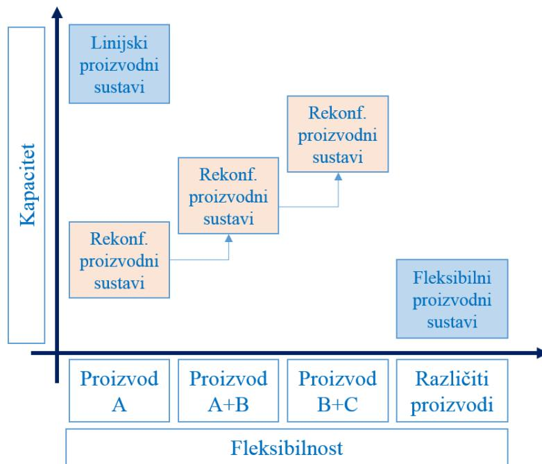
Slika 2.2 Područje primjene rekonfigurablenih proizvodnih sustava (Dashchenko, 2006)
