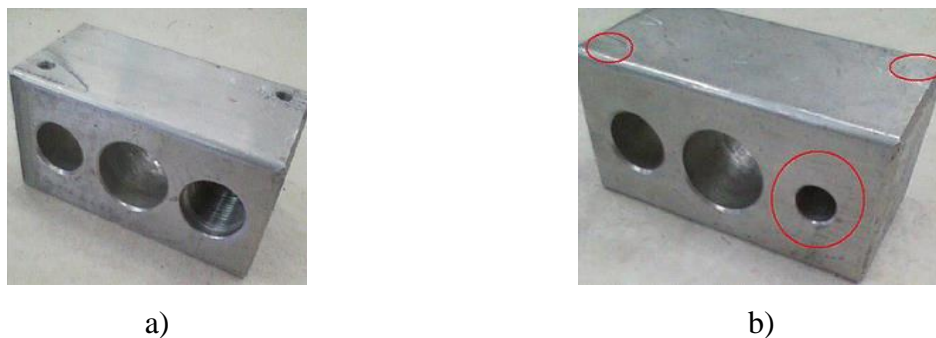
Slika 4.2 Primjer referentnog predmeta (a) i gotovog proizvoda (b) (Davrajh and Bright 2010)
