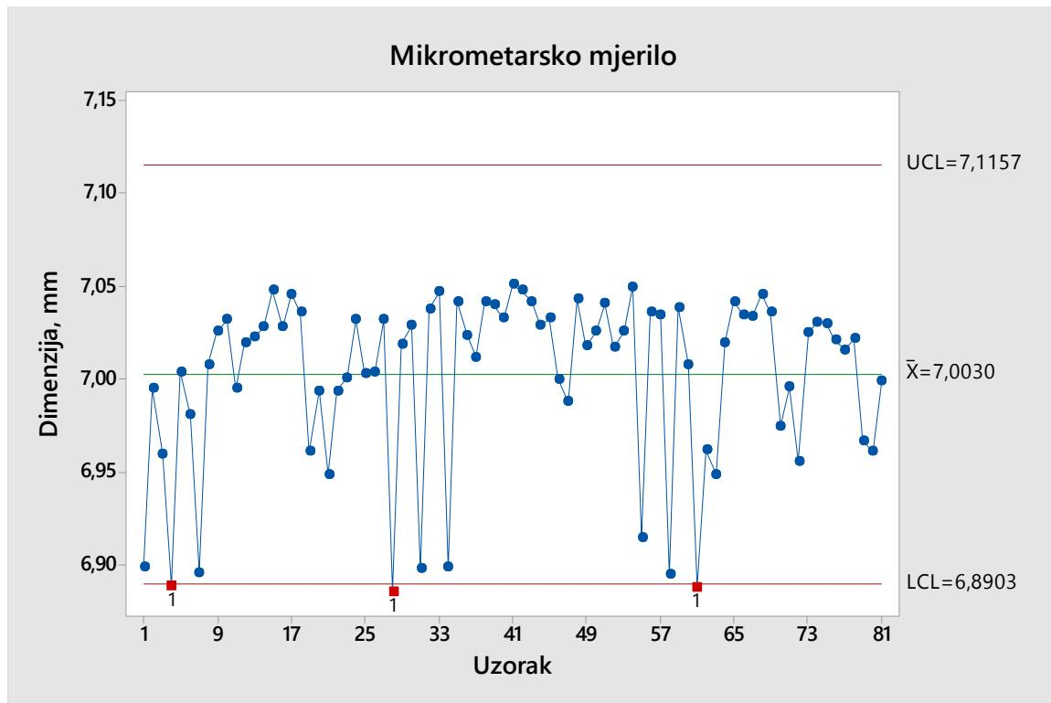
Slika 5.17 Kontrolna karta individualnih izmjera dobivenih mikrometarskim mjerilom
