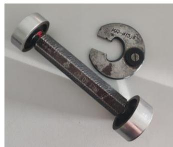
Slika 2.5 Mjerni trnovi i rašlje – princip „ide/ne ide“
