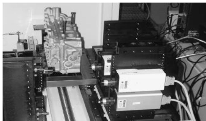
Slika 2.10 Rekonfigurabilni inspekcijski stroj sa svojim optičkim senzorima kojeg je predstavio (Koren, 2010)
