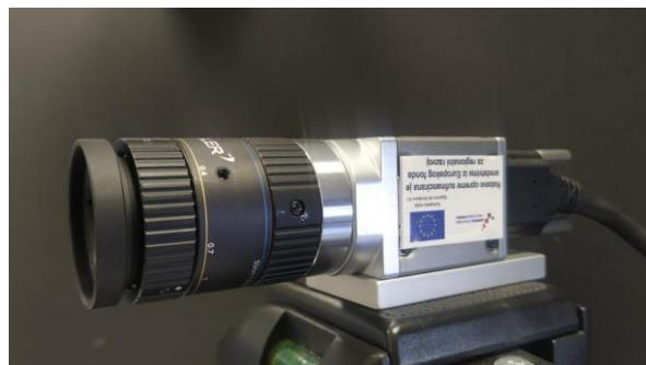
Slika 3.22 Spojeni sustav senzora i objektiva 50 mm
