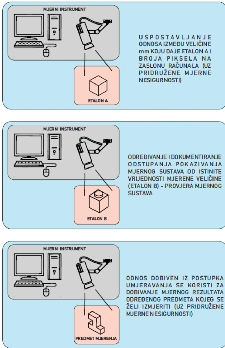
Slika 3.14 Slikoviti prikaz postupka mjerena i umjeravanja
