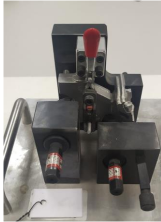
Slika 2.6 Specijalna mjerna naprava po principu „ide/ne ide“
