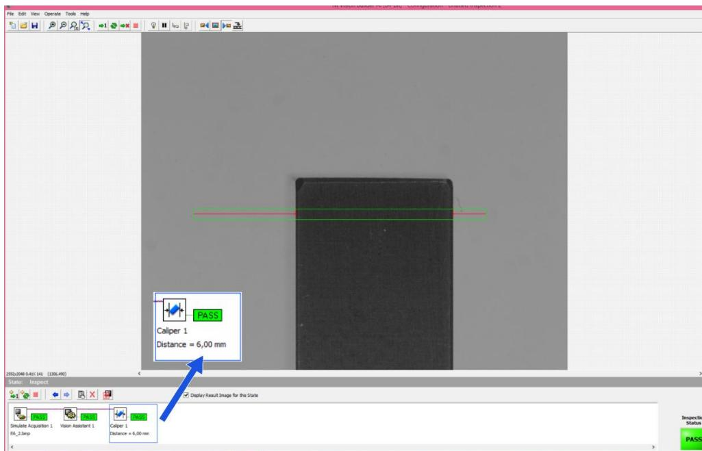
Slika 4.16 Provjeda mjerena duljina planparalelne granične mjerke duljine 6,00 mm
