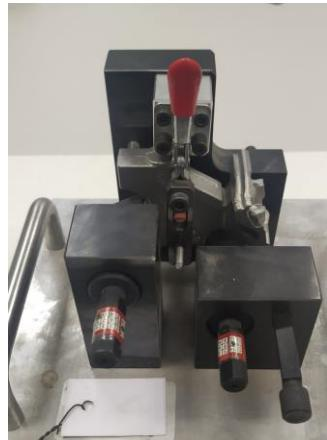
Slika 2.6 Specijalna mjerna naprava po principu „ide/ne ide“
