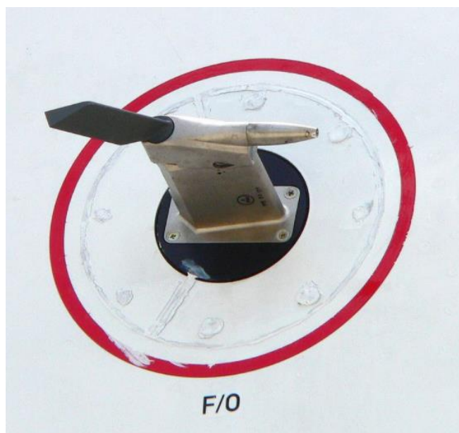
Slika 4.5. Pitotova cijev na zrakoplovu [8]
