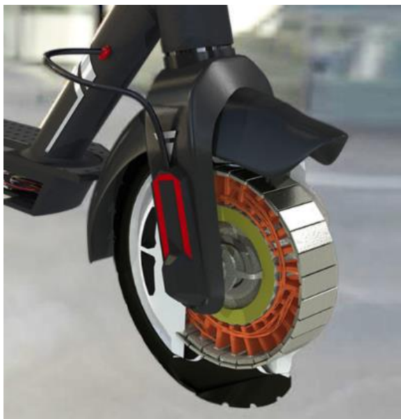
Slika 2.6.1. Motor integriran u kotač [14]
