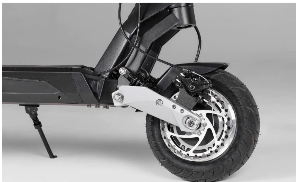
Slika 2.4.1. Disk kočnice električnog romobila [11]
