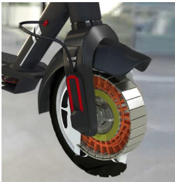
Slika 2.6.1. Motor integriran u kotač [14]
