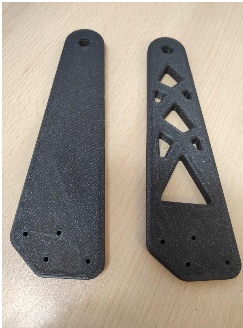
Slika 5.4.1. Ispisani modeli nastavka za prikolicu
