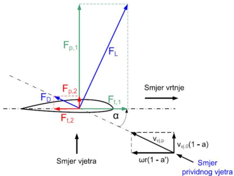
Slika 3.4 Prikaz djelovanja sile uzgona i sile otpora
