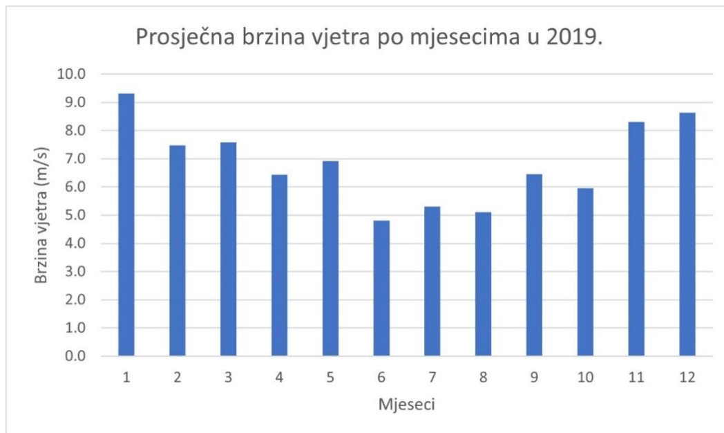
Slika 7.1. Iznosi prosječnih mjesečnih brzina vjetra na lokaciji
