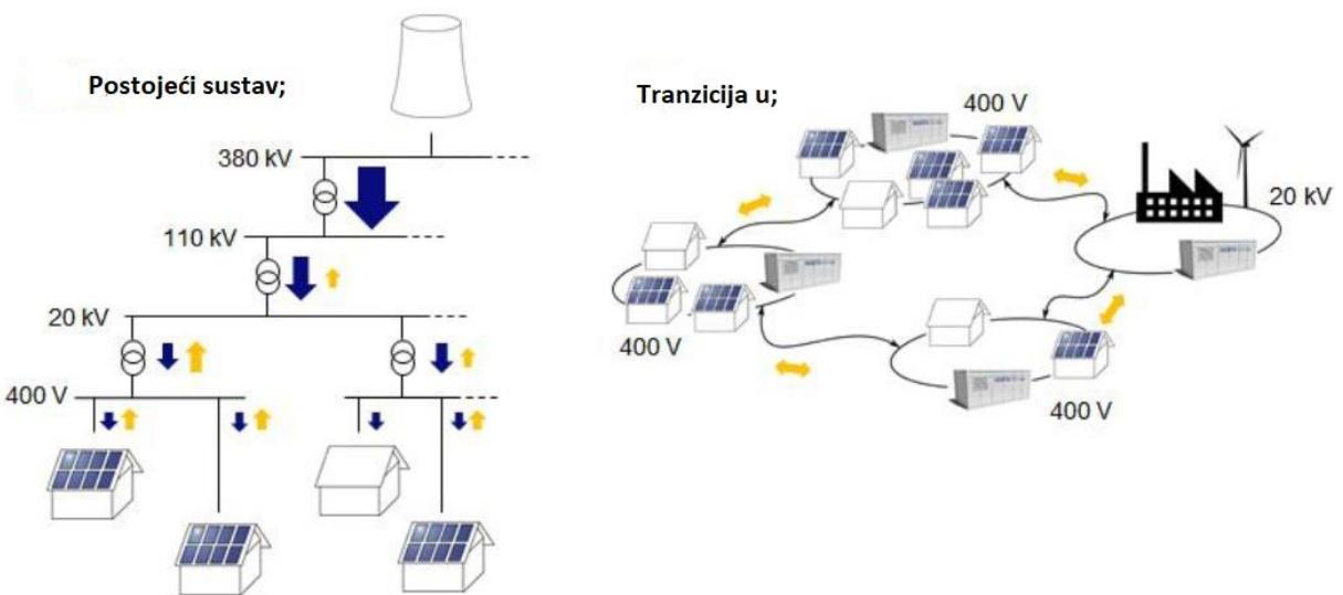
*Slika 18. Skica toka snage centralizirane i decentralizirane proizvodnje energije (lijevo), međusobno povezivanje energetskih celija (desno) [41]*
