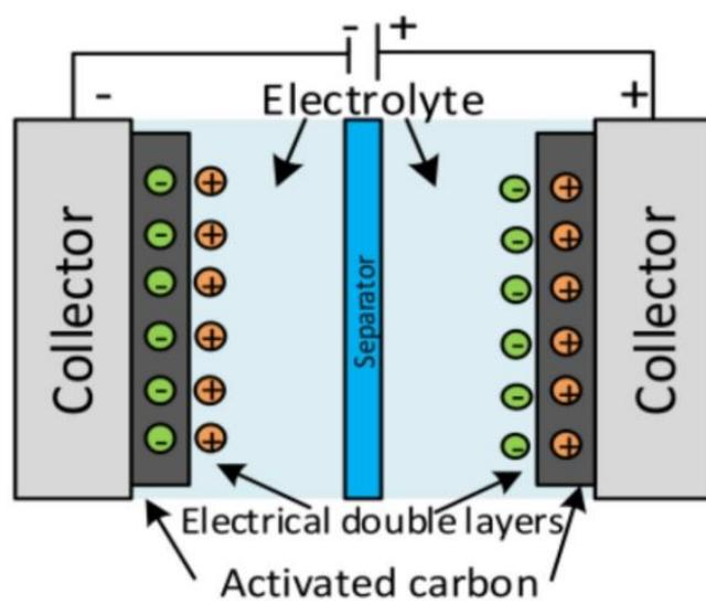
Slika 11. Struktura superkondenzatora [19]
