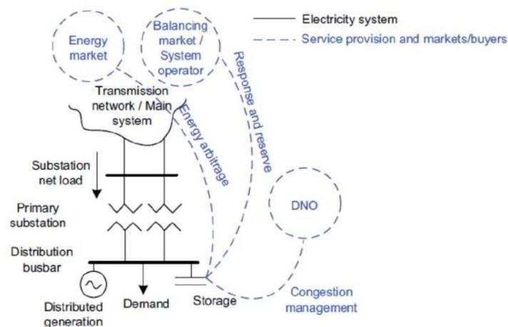
Slika 32. Prikaz pružanja više usluga distribuiranog sustava pohrane [32]
