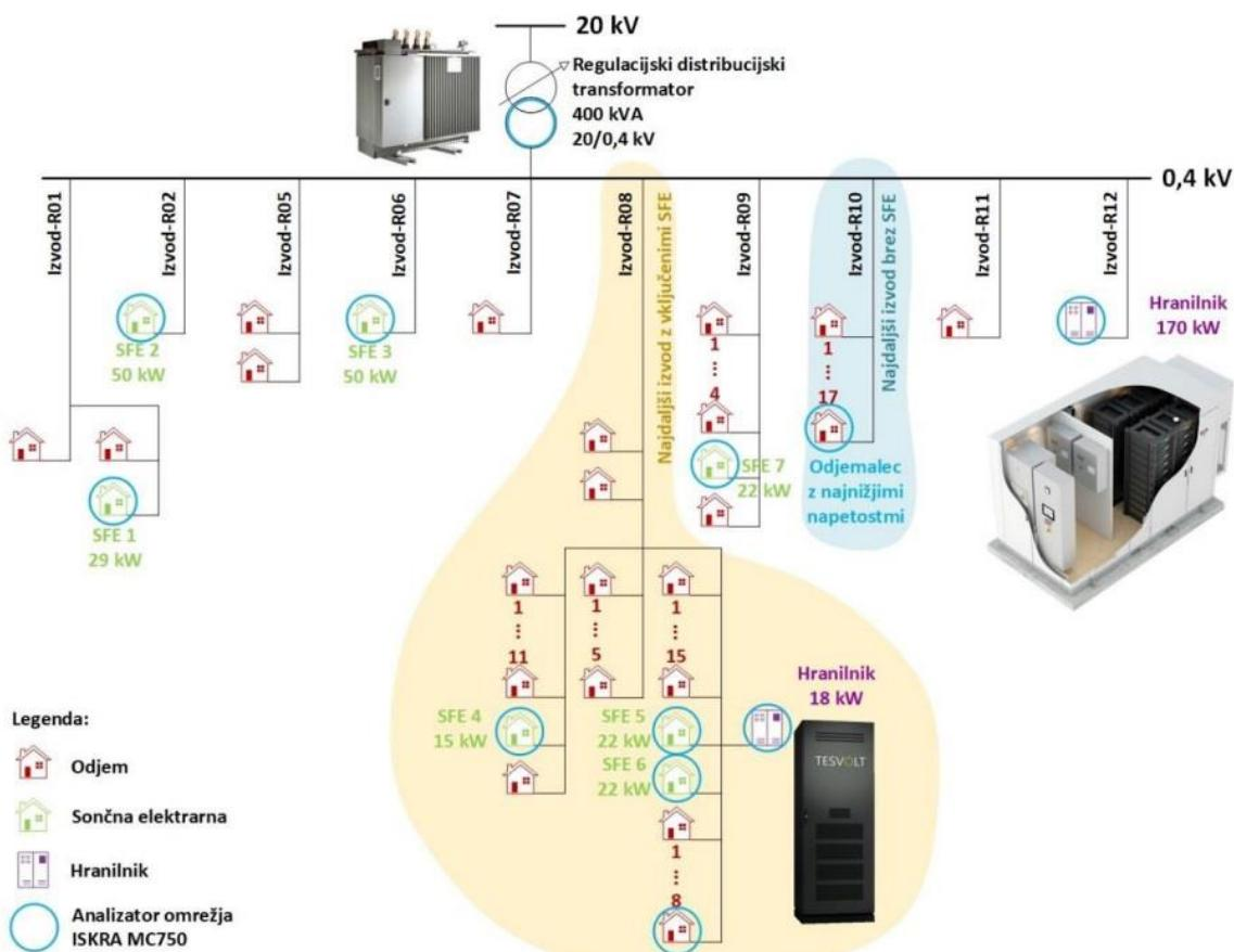
Slika 34. Jednopolna shema NNO-a napajanog preko TP Suha [45]
