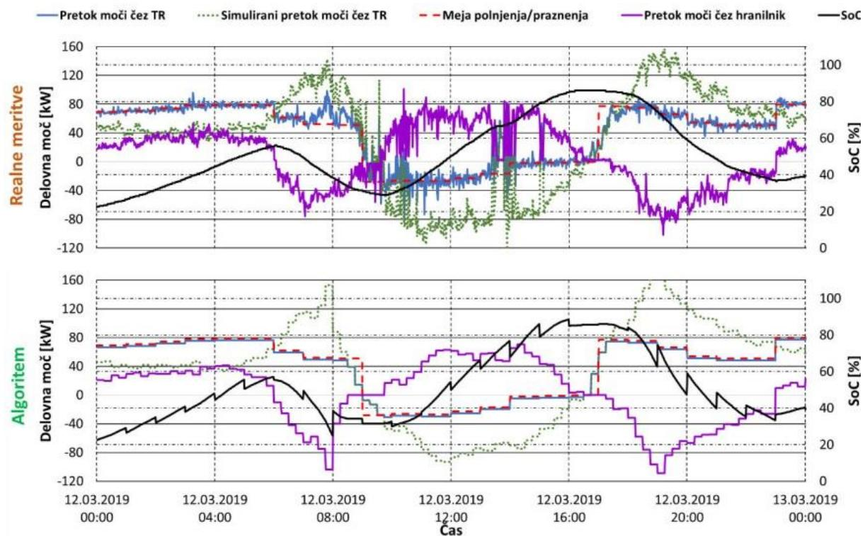
Slika 37. Rad algoritma za smanjenje vršnog opterećenja - sunčani dan [45]
