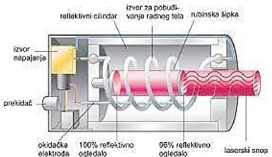
Slika 2.2. Dijelovi rubinskog lasera [5]
