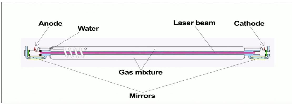
Slika 2.7. Konstrukcija  $\text{CO}_2$  lasera
