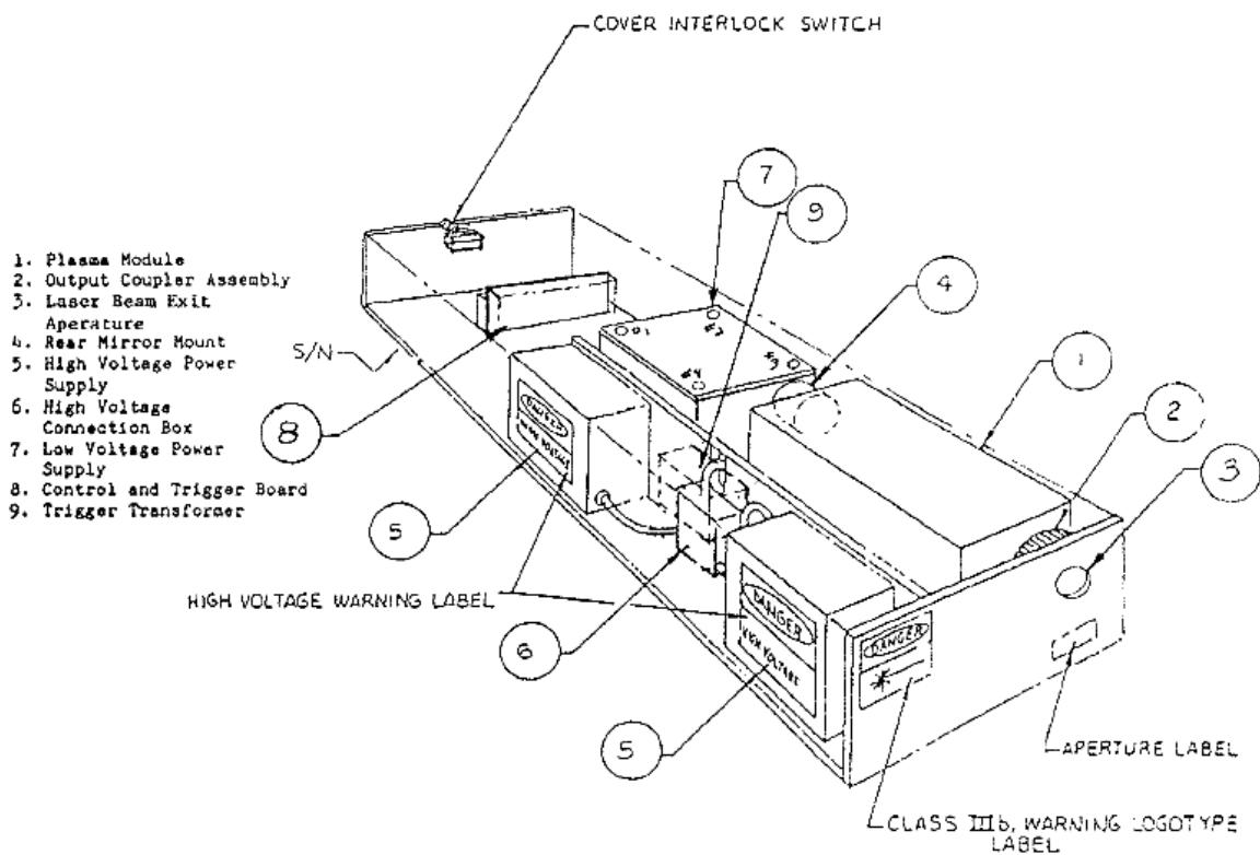
*Slika 2.8. Prikaz dušikovog lasera s osnovnim dijelovima sklopa*
