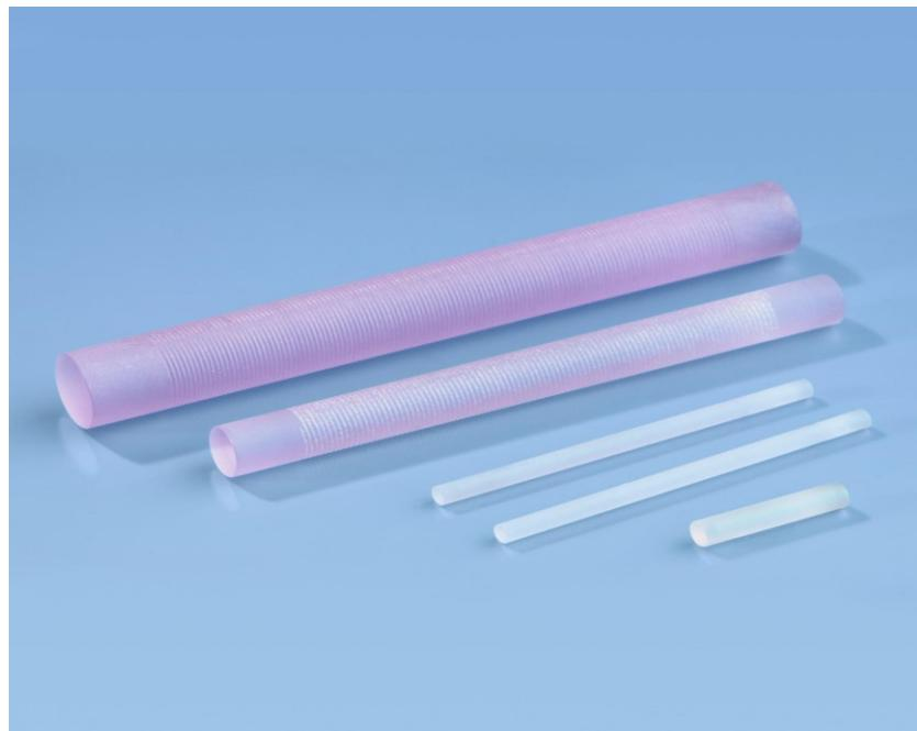
*Slika 2.3. Kristalni štapići Nd:Yag [6]*
