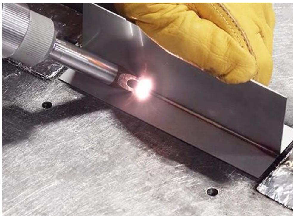
*Slika 3.1. Lasersko zavarivanje tankostjenih ploča od aluminija [8]*
