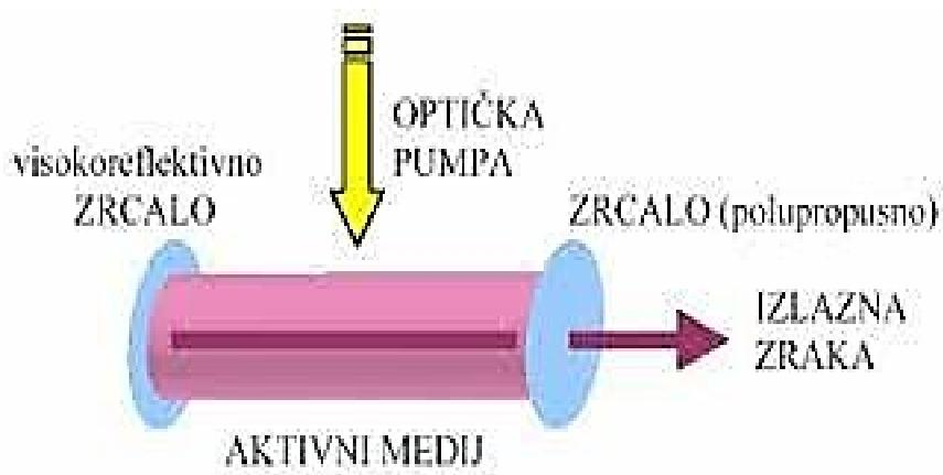
Slika 2.1. Osnovni dijelovi lasera [4]
