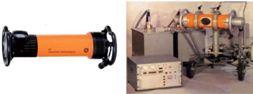
Slika 3.20. Prijenosni i stacionarni rendgenski uređaj [19]
