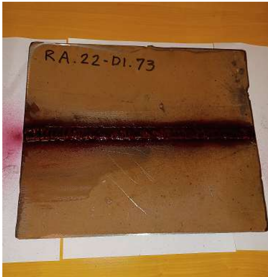
Slika 4.6. Prikaz nanesenog penetranta
