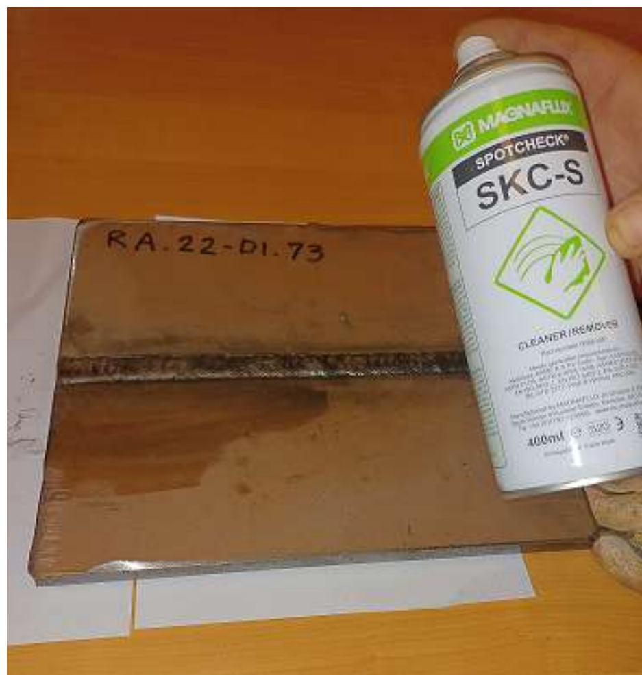
Slika 4.5. Čišćenje ispitne površine
