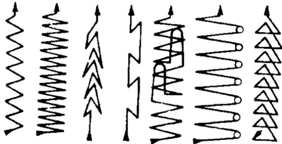
Slika 2.5. Moguća poprečna kretanja elektrode
