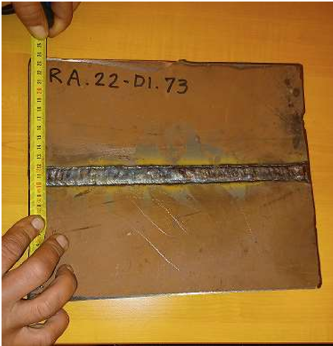
Slika 4.2. Mjerenje dimenzija zavara (širine) metrom
