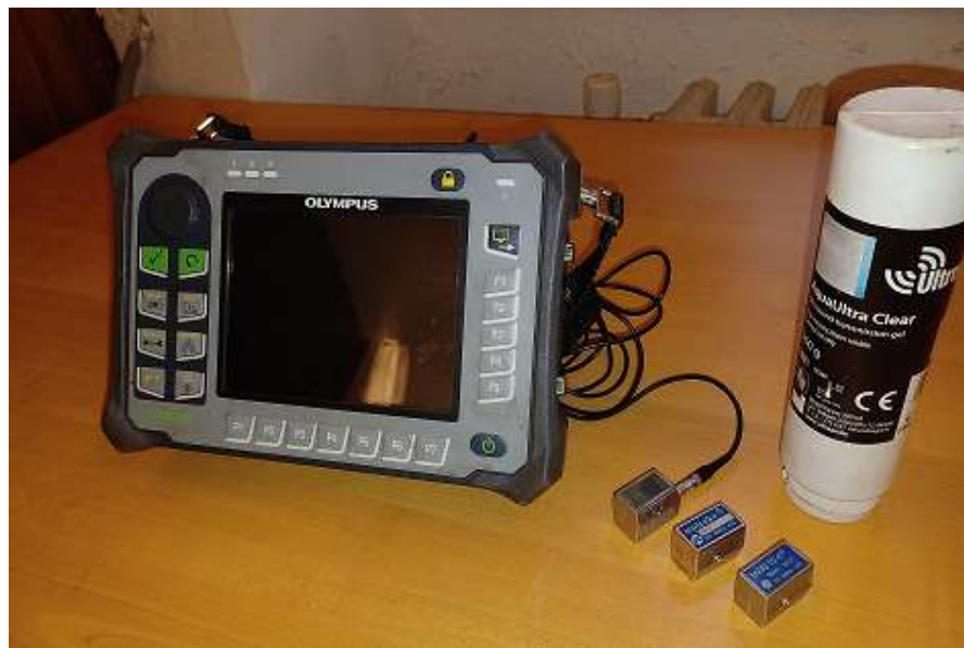
Slika 4.9. Ultrazvučni aparat OLIMPUS EPOCH 650
