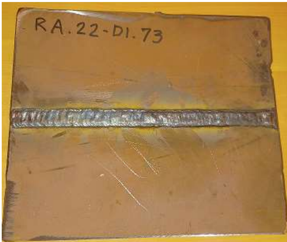
Slika 4.1. Ispitna ploča RA.22-DI.73
