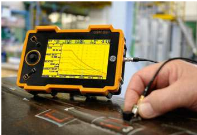
Slika 3.13. Oprema za ispitivanje ultrazvukom [17]
