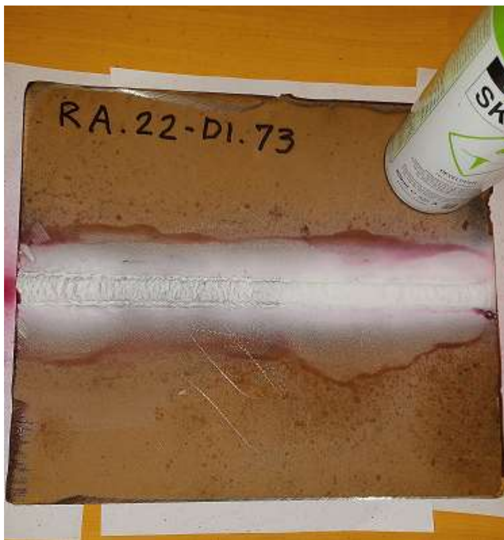
Slika 4.7. Slika nakon nanošenja i sušenja razvijajuća
