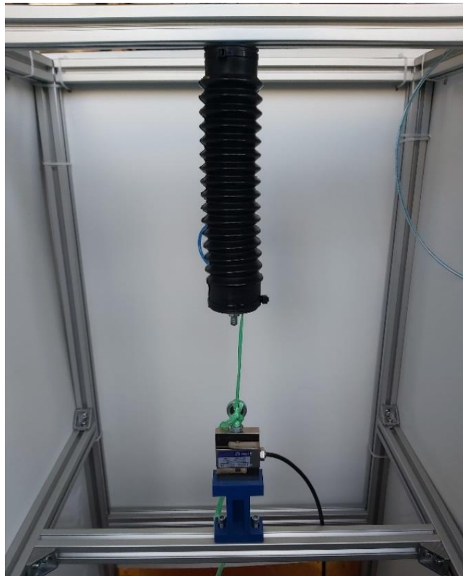
Slika 6.2 Konačni prikaz montaže mišića i njegove povezanosti sa senzorom
