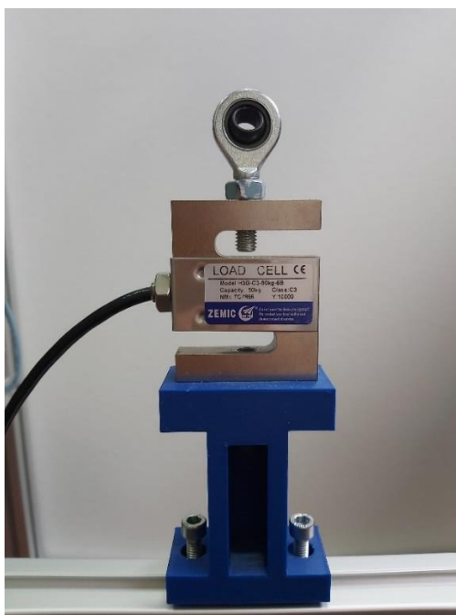
Slika 5.7 Senzor sile Zemic H3G-C3-50kg-6B postavljen na njegov prihvat
