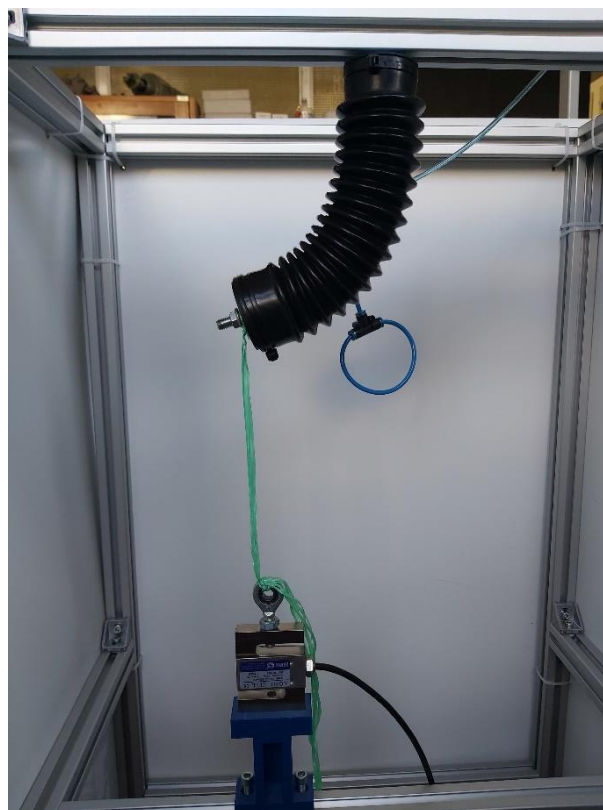
Slika 6.8 Mjerenje sile za kutni pomak od 90°
