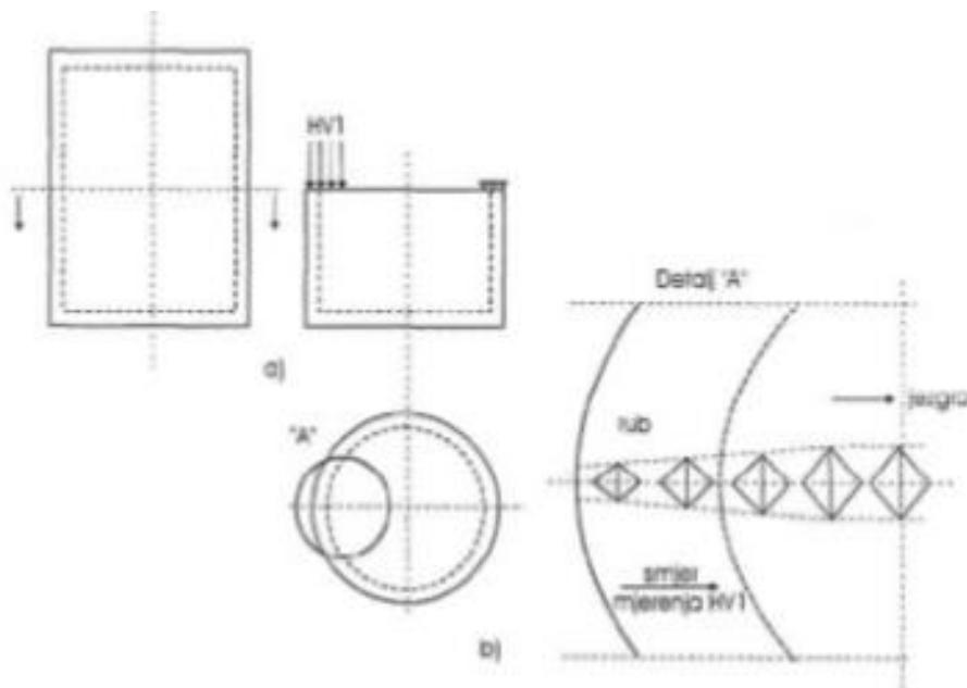
Slika 5.1. - Shematski prikaz utvrđivanja dubine cementiranog sloja i mjerjenje tvrdoće Vickersovom metodom [23]
