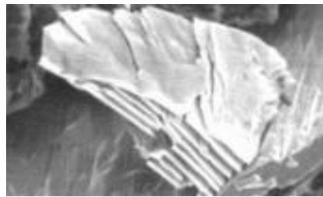
Slika 2.7. – Mikrostruktura perlita [6]
