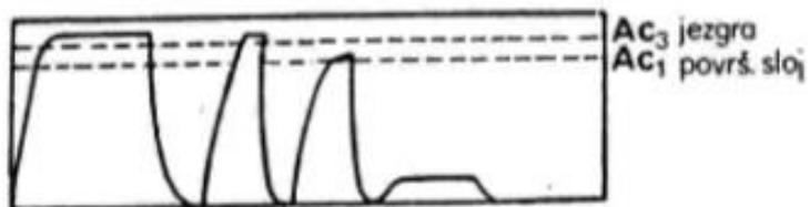
*Slika 3.15. – Dvostruko kaljenje [15]*
