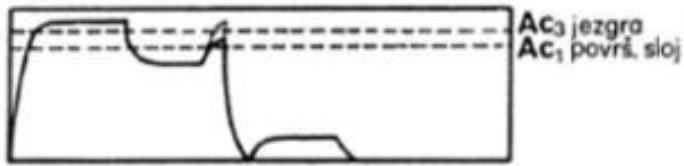
*Slika 3.14. - Jednostruko kaljenje nakon izotermičke pretvorbe [15]*
