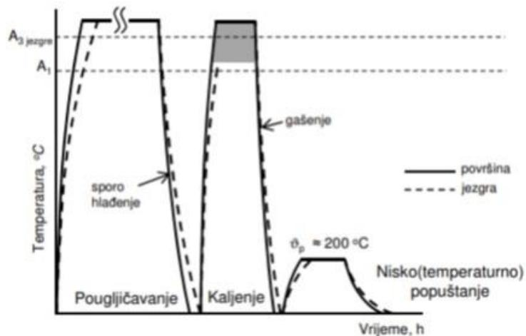
Slika 3.2. – Grafički prikaz procesa cementiranja čelika [13]
