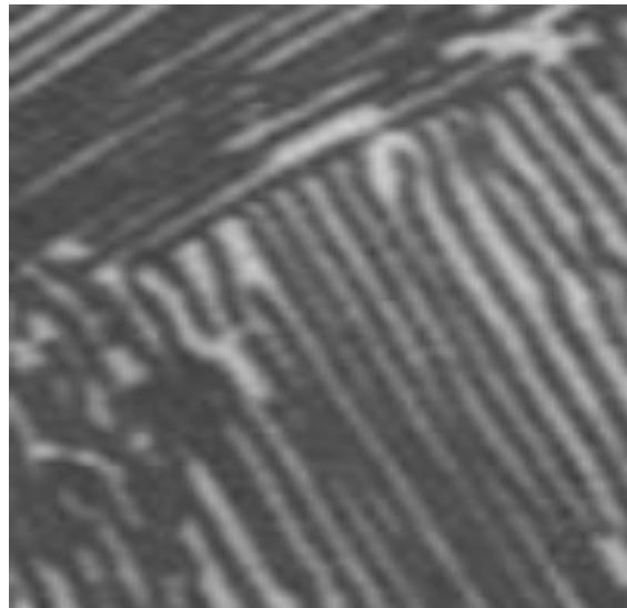
Slika 2.6. – Mikrostruktura cementita [2]
