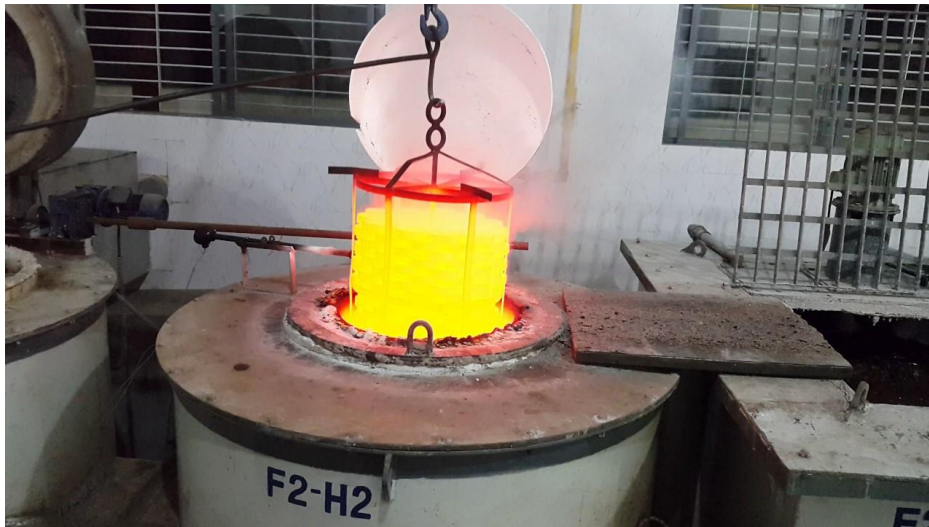
Slika 3.8. – Pougličavanje u solnoj kupki [18]
