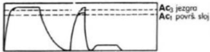
*Slika 3.12. – Jednostruko kaljenje [15]*
