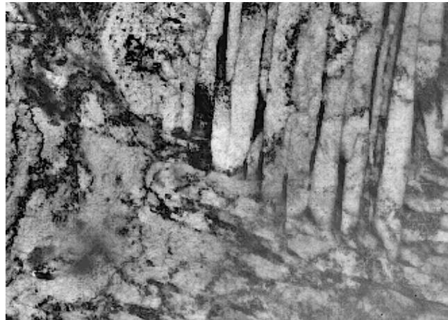
Slika 2.10. – Mikrostruktura bainita [9]
