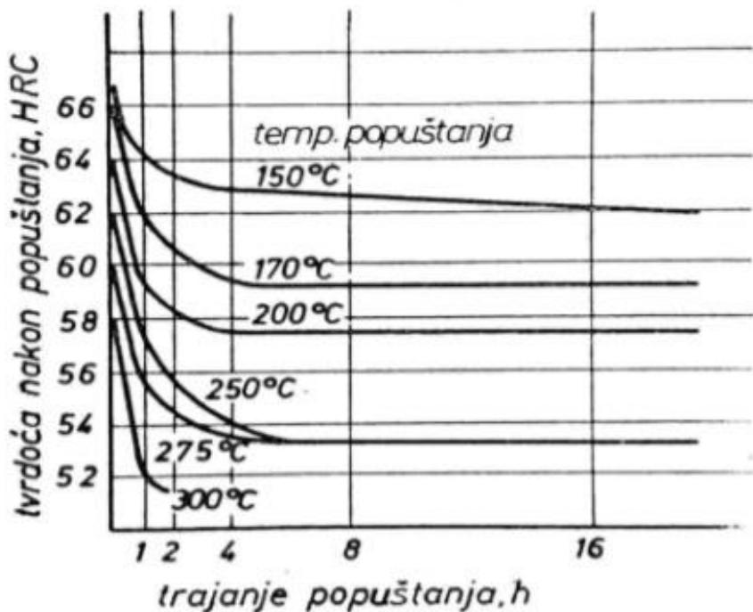
Slika 3.18. - Utjecaj temperature i vremena na tvrdoću čelika [13]
