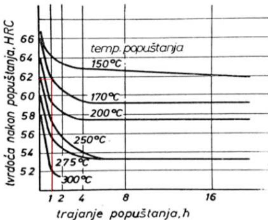
Slika 6.4. – Niskotemperaturno popuštanje za strojni dio NJ.22-PT.41
