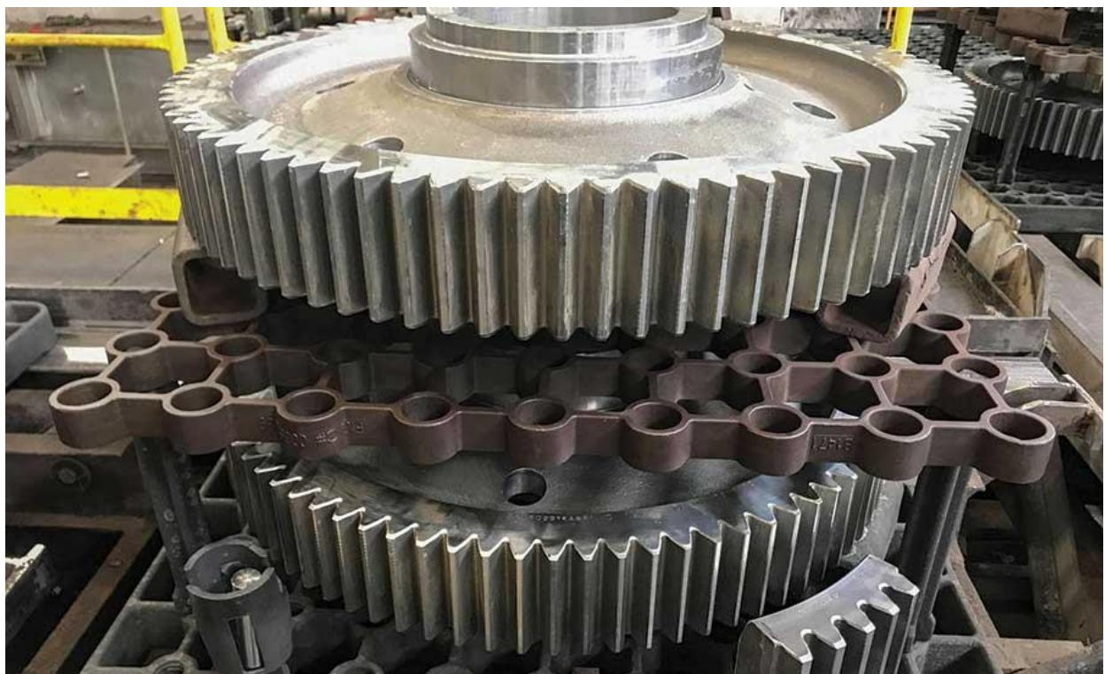
Slika 3.1. - Zupčanici stroja izrađeni od cementiranog čelika [12]
