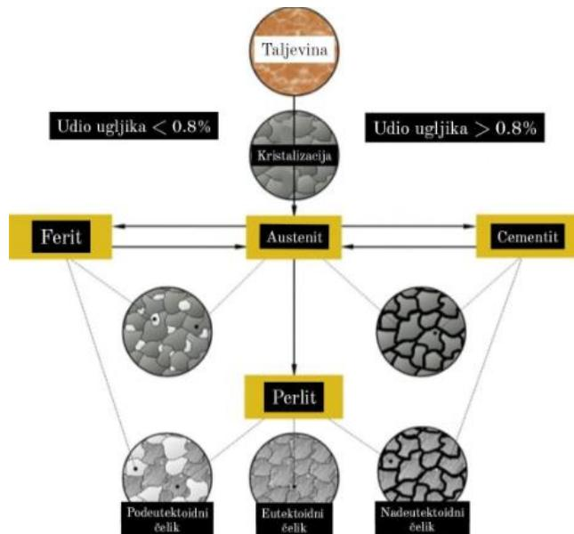
Slika 2.11. – Pojednostavljeni prikaz faznih pretvorbi čelika [10]
