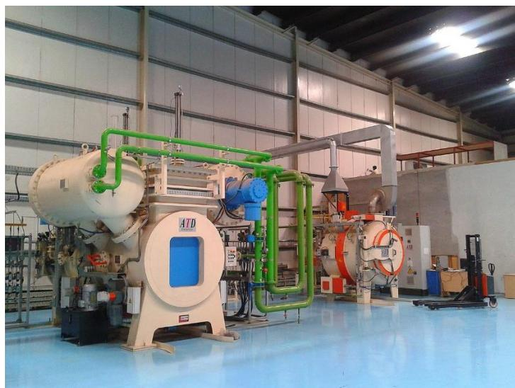
Slika 3.9. - Moderno postrojenje za pougljičavanje u plinu [19]
