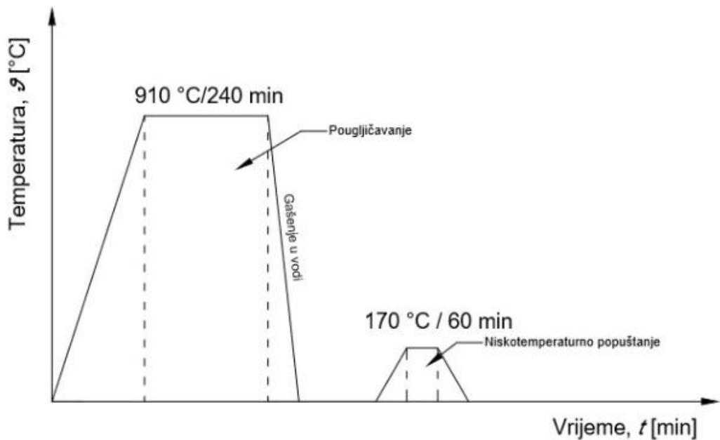
Slika 6.5. – Proces cementiranja strojnog dijela NJ.22 – PT.41
