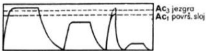
*Slika 3.13. - Jednostruko kaljenje nakon međužarenja [15]*
