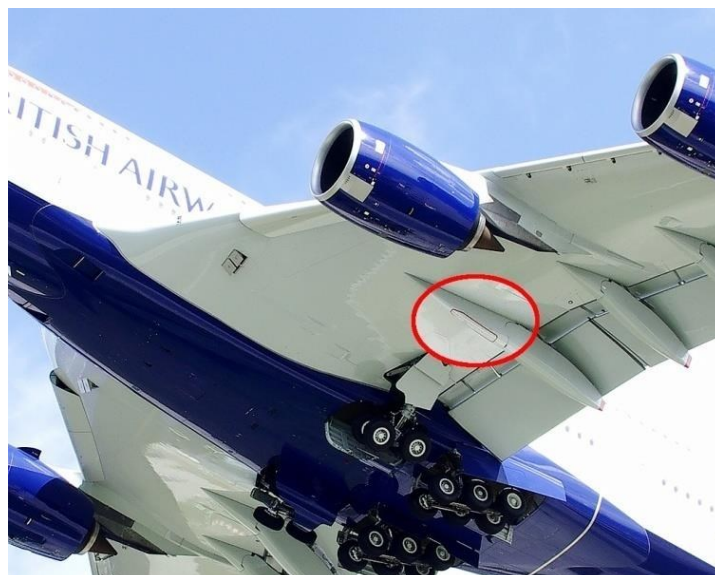
Slika 2. 1. Kućište ram zračne turbine [4]
