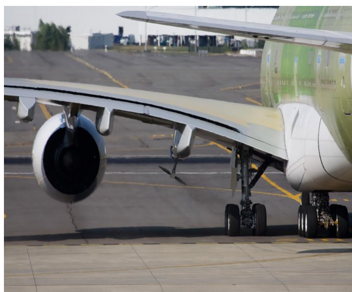
Slika 2. 2. Ram zračna turbina u radu [5]
