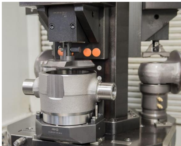
Slika 2.4. Prikaz hidrauličkog stezanja pomoću hidrauličke stezne naprave [4]
