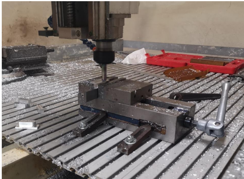
Slika 7.4. Strojna obrada graničnika
