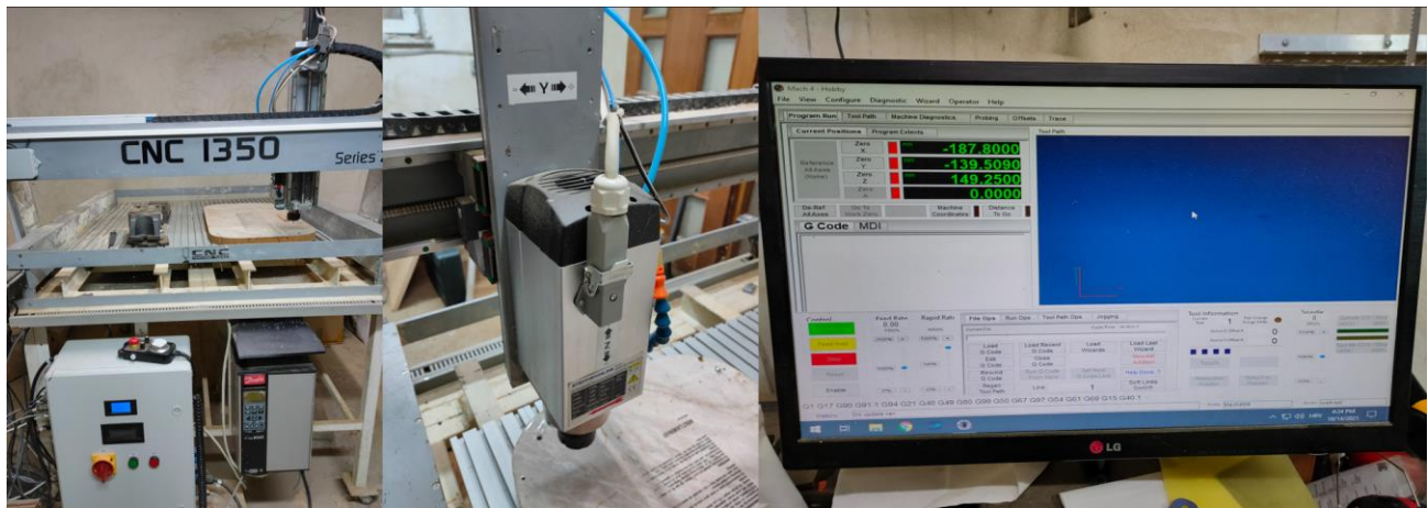
Slika 6.1. Korišteni stroj - CNC glodalica kućne izrade
