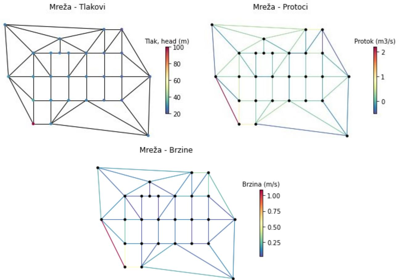
Slika 6.3. Raspodjela tlakova, protoka i brzina u cjevovodima
