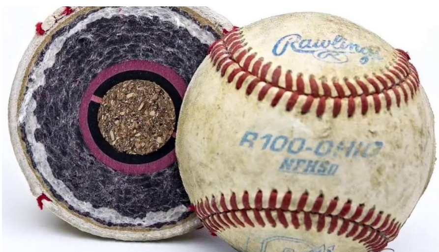
Slika 4.9. Poprečni presjek bejbol lopte [80]
