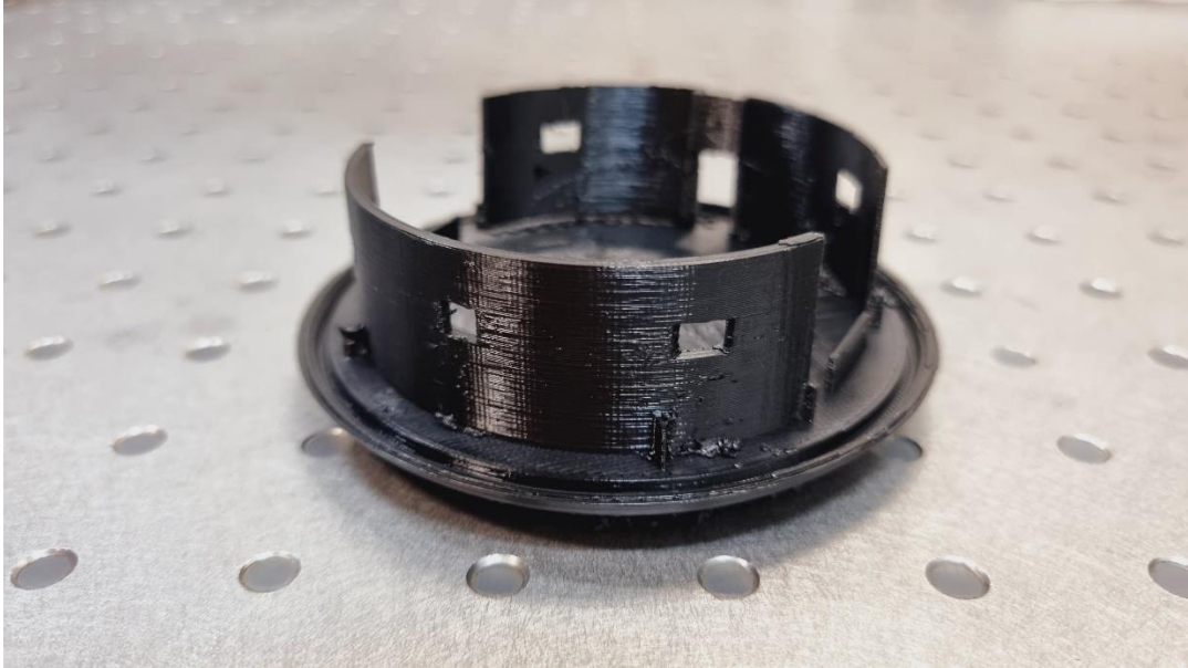
Slika 7-20 Poklopac od ventilacije automobila izgrađen 3D printerom (uspješno isprintani model)
