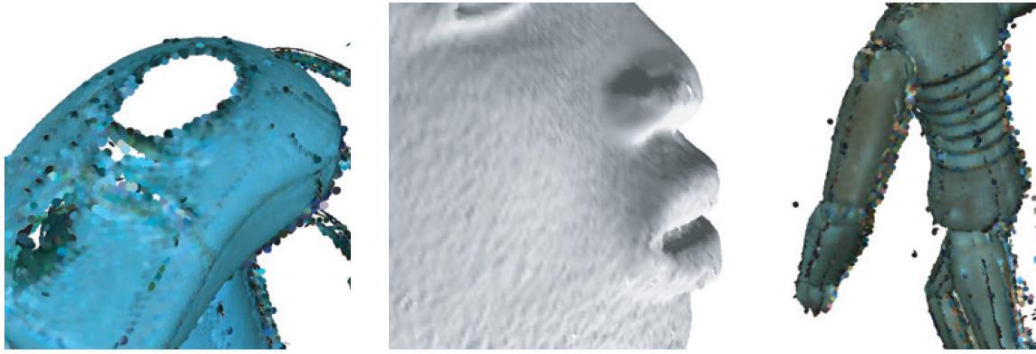
Slika 4-2 Tipični detalj rezultata skeniranja u obliku oblaka točaka, prije obrade podataka [1]
