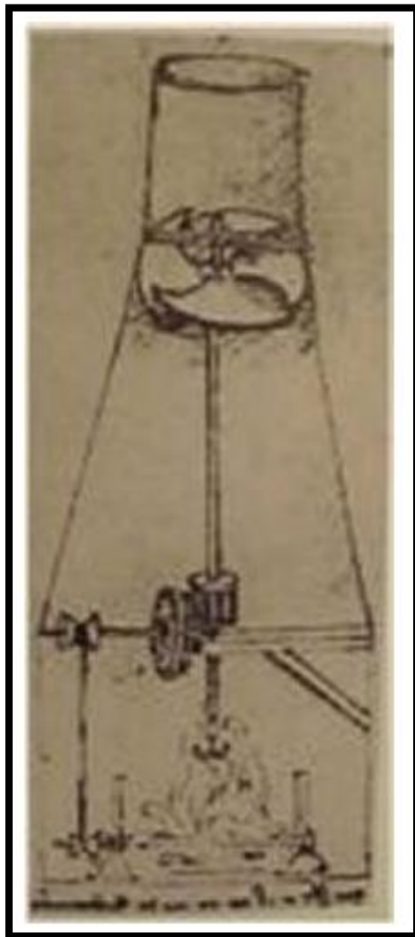
Slika 2.2. da Vincijska turbina
