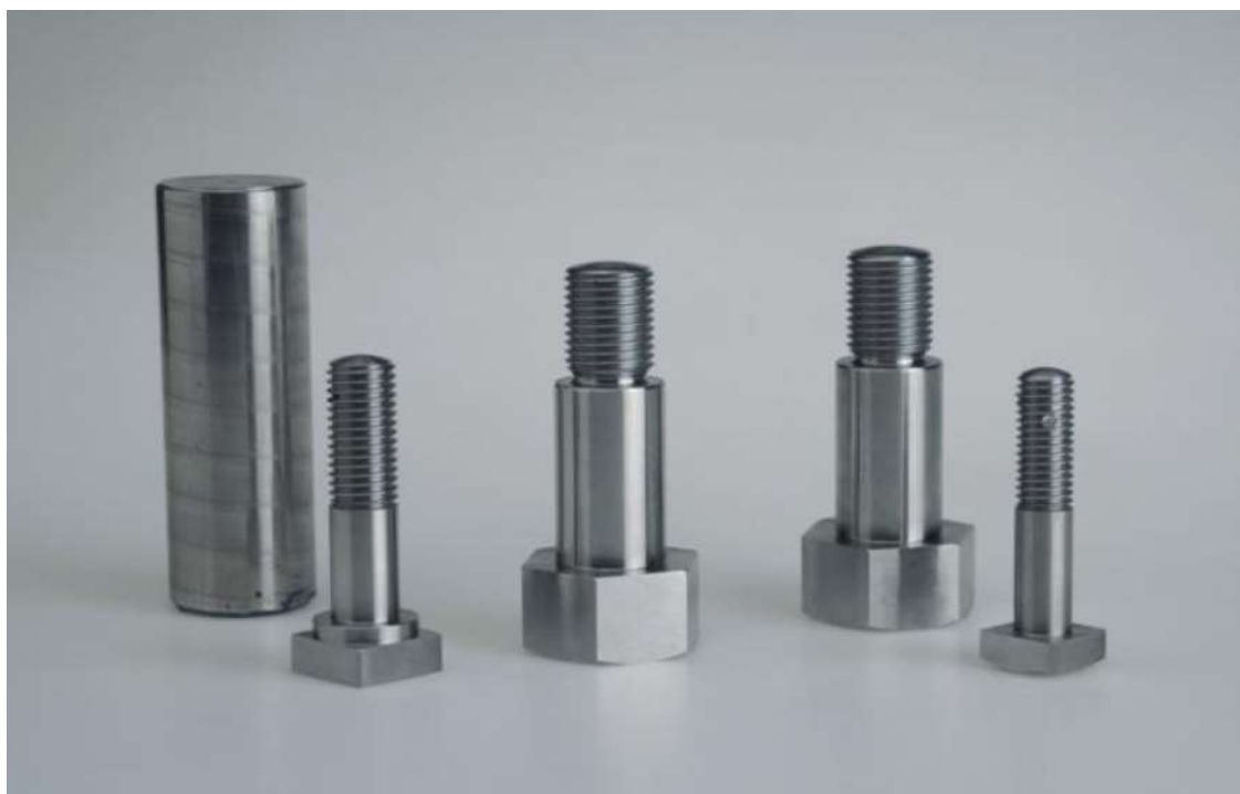
Slika 2.1 Šesterokutne glave vijaka izrađene postupkom poligonalnog tokarenja
