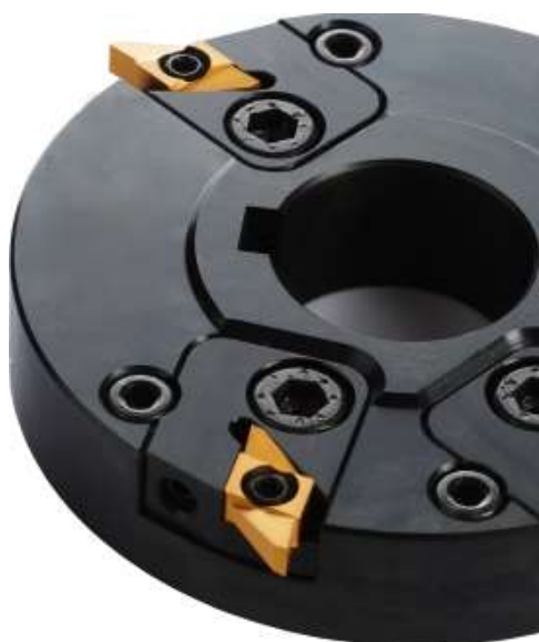
Slika 2.3 Držač alata sa podešivim utorima za rezne pločice proizvođača Dieterle [6]
