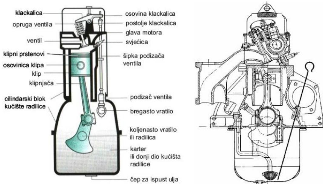
Slika 4.1. Model jednostavnog motora s unutarnjim izgaranjem [20]
