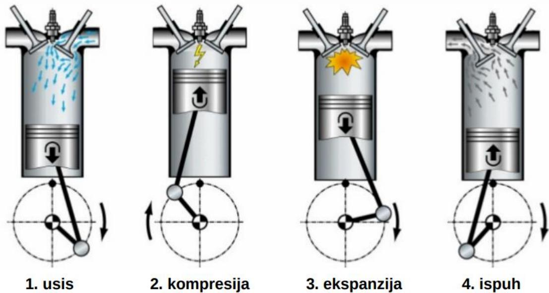
Slika 4.2. Četiri faze četverotaktnih motora [20]
