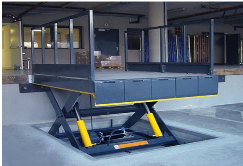
Slika 2.4. Postolje ugrađeno u posebnoj rupi [8]
