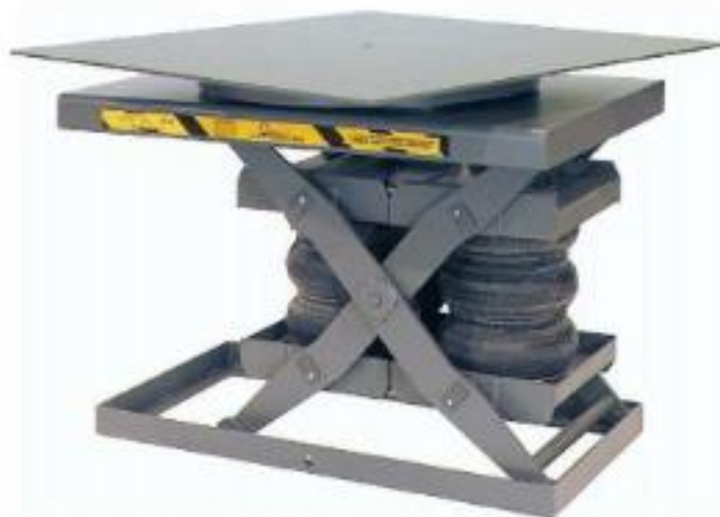
Slika 2.18. Podizna platforma s pneumataskim pogonom [8]
