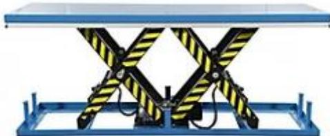
Slika 2.8. Tandemska izvedba škarastog mehanizma [5]
