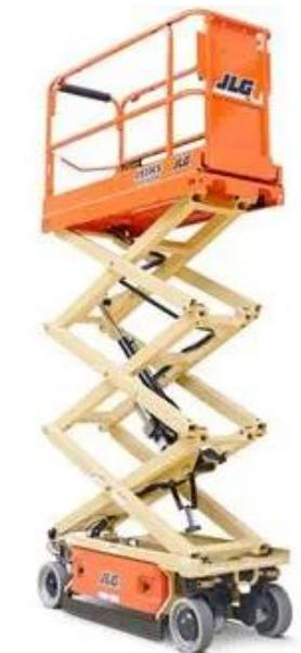
Slika 2.2. Podizna platforma s transportnim postoljem [7]
