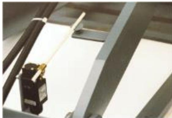
*Slika 2.14. Kontaktni senzor [5]*
