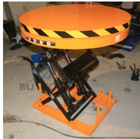
Slika 2.9. Platforma s napravom za okretanje [7]
