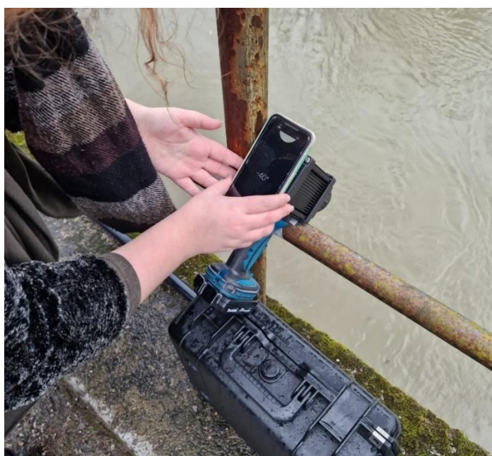
Slika 4.7 Provjera nagiba radarskog uređaja pomoću mobilne aplikacije
