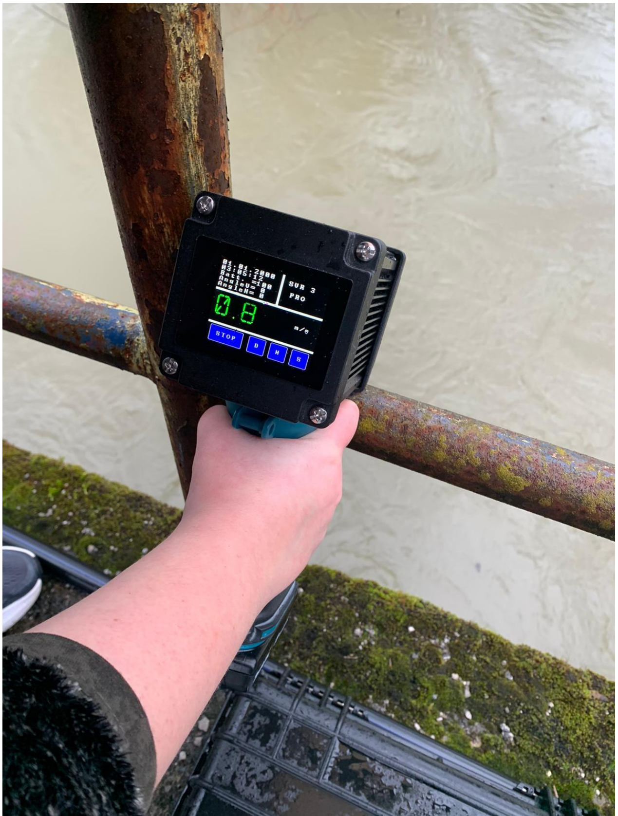
Slika 4.8 Mjerenje površinske brzine strujanja vode na jednoj od pozicija
