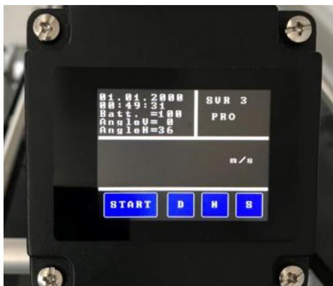
Slika 2.3 LCD zaslon radarskog uređaja Viatronics model VT-SVR-PRO 3
