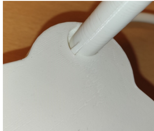
Slika 3.34. Utor na postolju (lijevo) i izbočina na cijevi (desno) – nalijegajući spoj
