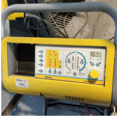
Slika 4.29. Uređaj i pištolj za ručno nanošenje praha
