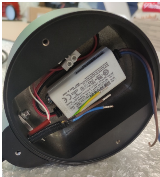
Slika 4.44. Unutrašnjost glave i postolja svjetiljke
