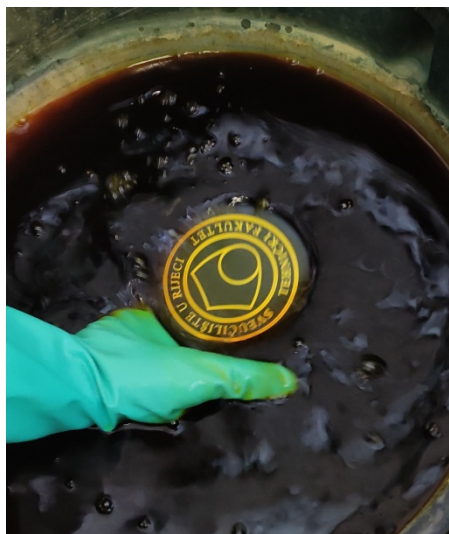
Slika 4.41. Gotovo graviranje (lijevo); kromatiranje gravure (desno)
