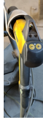
Slika 4.29. Uređaj i pištolj za ručno nanošenje praha
