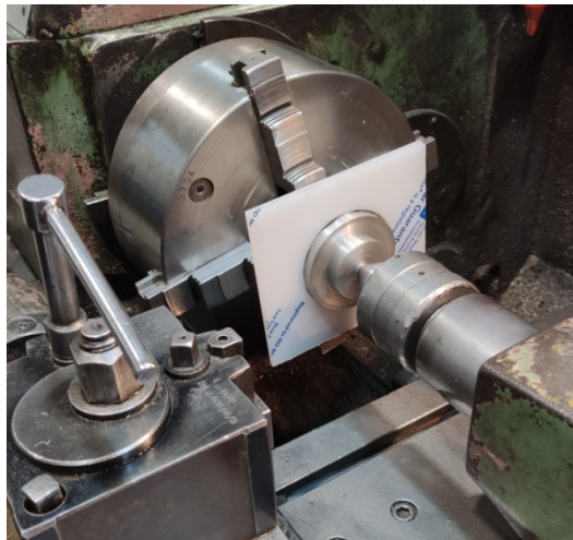
Slika 3.37. Sirovi komad akrilnog stakla u napravi
