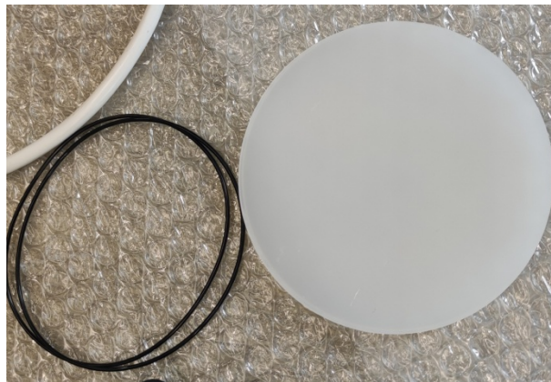
Slika 3.38. O-ring i akrilno staklo nakon tokarenja
