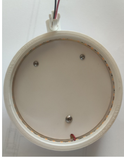
Slika 3.40. Poklopac za zatvaranje prostora s dekorativnom elektronikom
