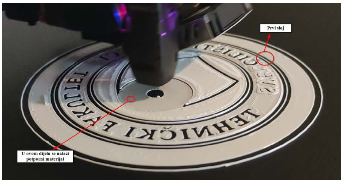
Slika 3.32. Prvi sloj printanja
