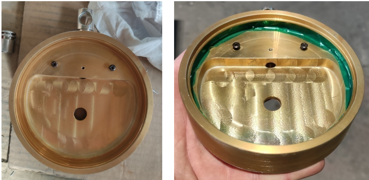
Slika 4.38. Kromatirana glava i pocinčani okretni vijak (lijevo); ljepljenje trake za sprječavanje plastificiranja (desno)
