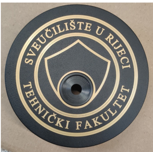
Slika 4.42. Izgled gravura nakon kromatiranja
