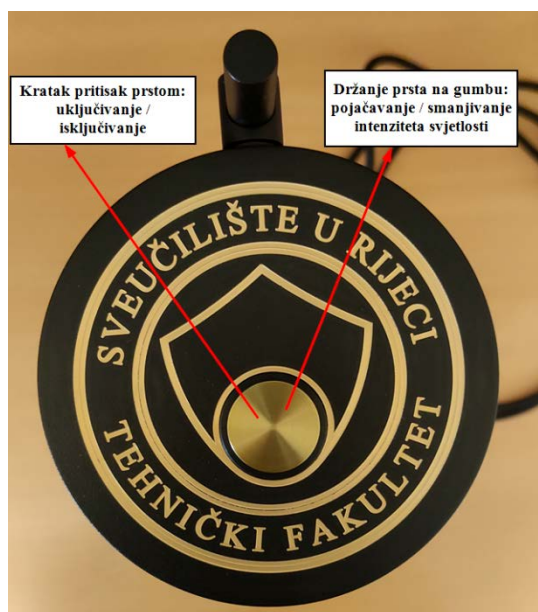
Slika 4.45. Princip rada svjetiljke
