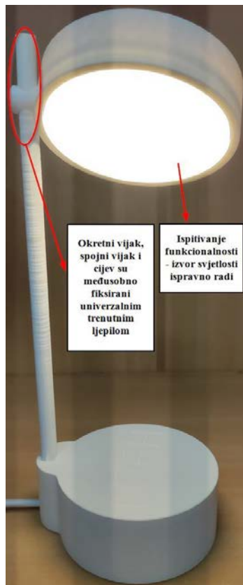
Slika 3.43. Sklop prototipa - izvor svjetlosti
