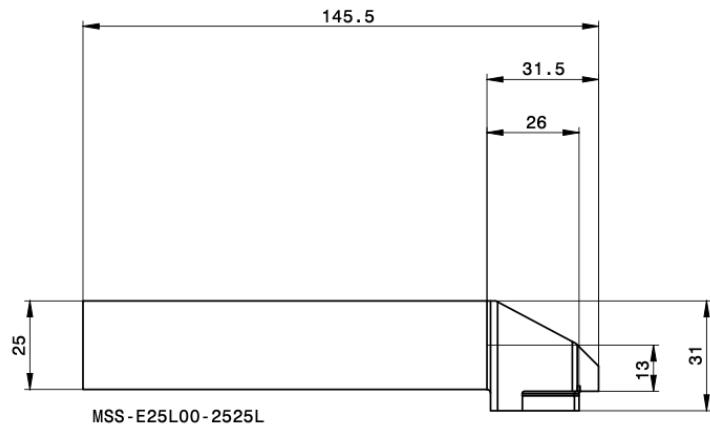
Slika 5.22. Alat za izradu utora - MSS-E25L00-2525L
