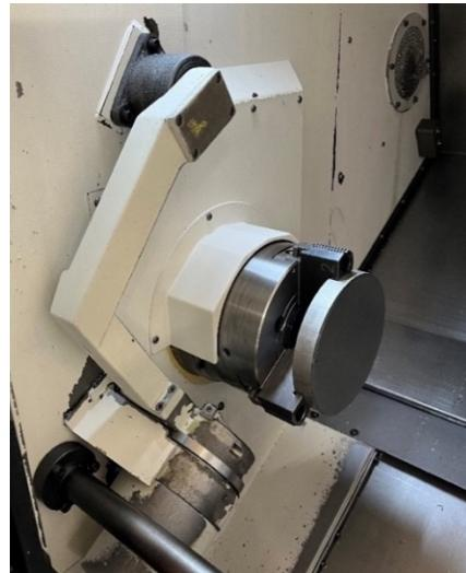
*Slika 5.7. Stezanje ulaznog materijala za pripremu za tokarenje strane 100*
