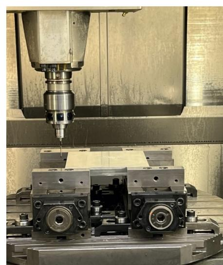
*Slika 5.47. Stvarno stezanje ulaznog materijala za obradu naprave*
