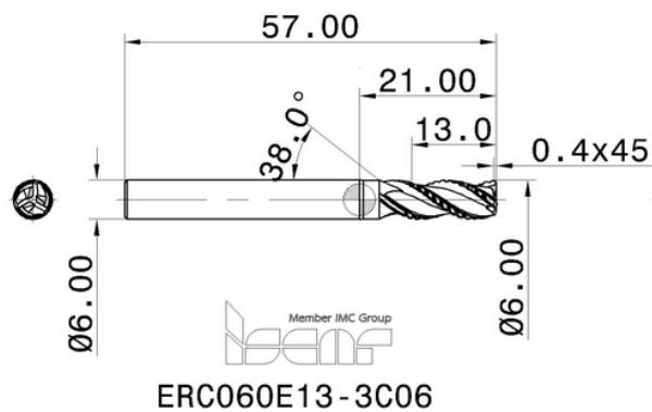
Slika 5.59. Glodalno Ø6 za grubu obradu
