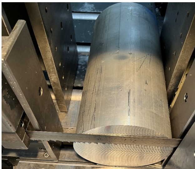
Slika 5.3. Postavljanje nule u procesu piljenja
