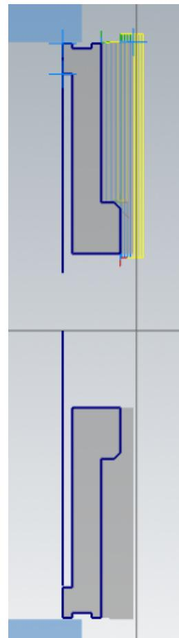
Slika 7.61. Pozicija u steznim čeljustima za tokarenje strane 200
