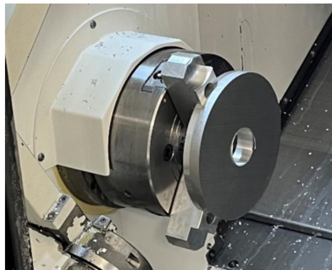
Slika 5.17. Stezanje ulaznog materijala za operaciju 30
