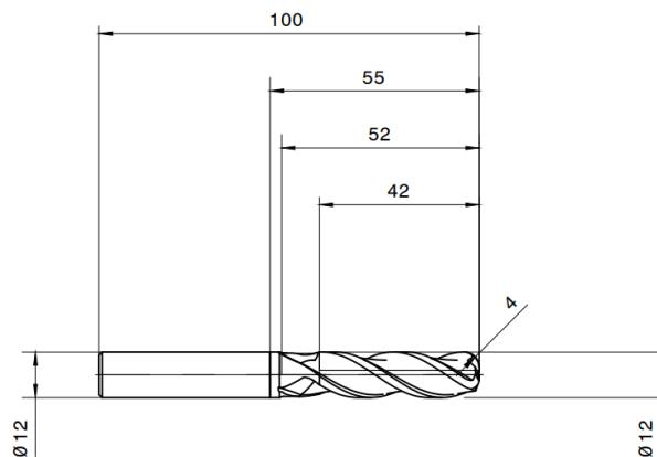
Slika 5.64. Glodalo  $\varnothing 12$  za fino glodanje
