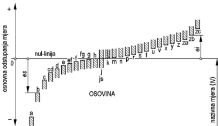
Slika 4.9. Položaj tolerancijskih polja za vanjske izmjere (osovine)
