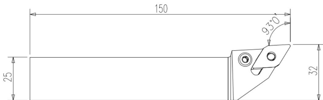
*Slika 5.8. Alat za vanjsko grubo tokarenje - PDJNR2525M15*
