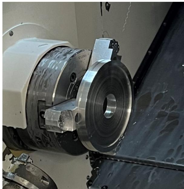
Slika 5.35. Stezanje ulaznog materijala za operaciju 40
