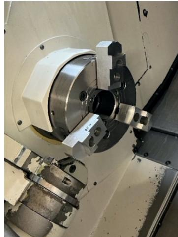
Slika 5.16. Stezna glava s aluminijskim čeljustima za operaciju 30
