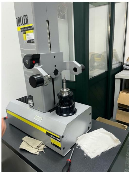
Slika 5.50. Umjeravanje alata
