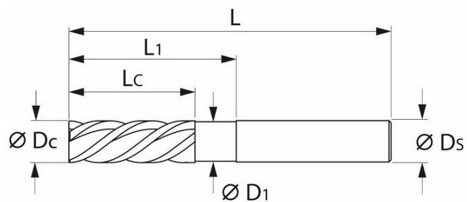
Slika 5.55. Glodalo  $\varnothing 6$  za finu obradu
