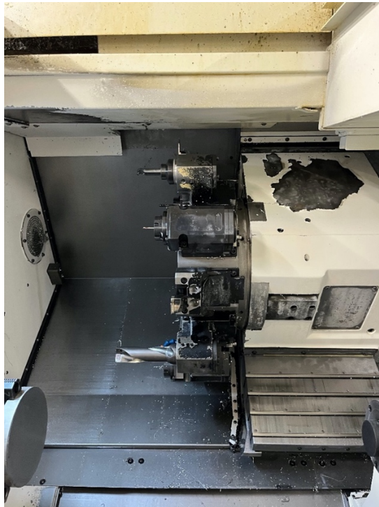
Slika 4.4. Revolverska glava (12 pozicija alata)
