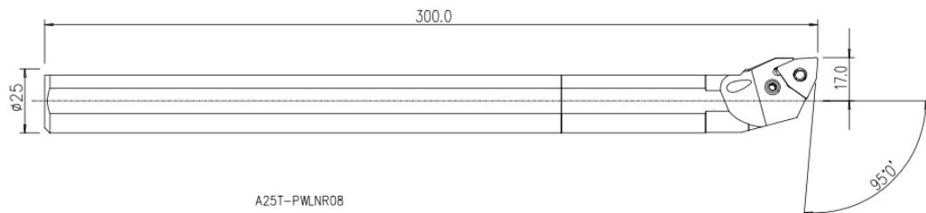
Slika 5.19. Alat za unutarnje grubo tokarenje - A25T-PWLNR 08
