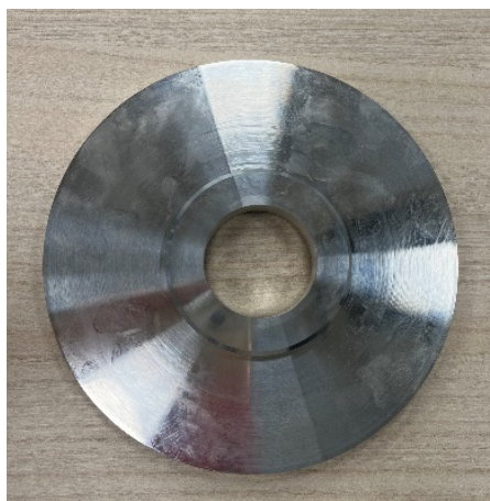
Slika 5.42. Transportno kolo nakon operacije 40-1
