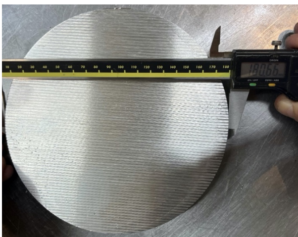
Slika 5.5. Kontrola dimenzije promjera šipke
