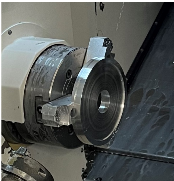
Slika 5.35. Stezanje ulaznog materijala za operaciju 40
