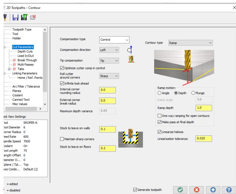
Slika 7.107. Definiranje parametara rezanja (OP70)
