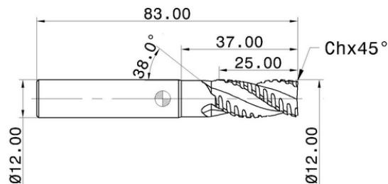
*Slika 5.49. Glodalo Ø12 za grubo glodanje*
