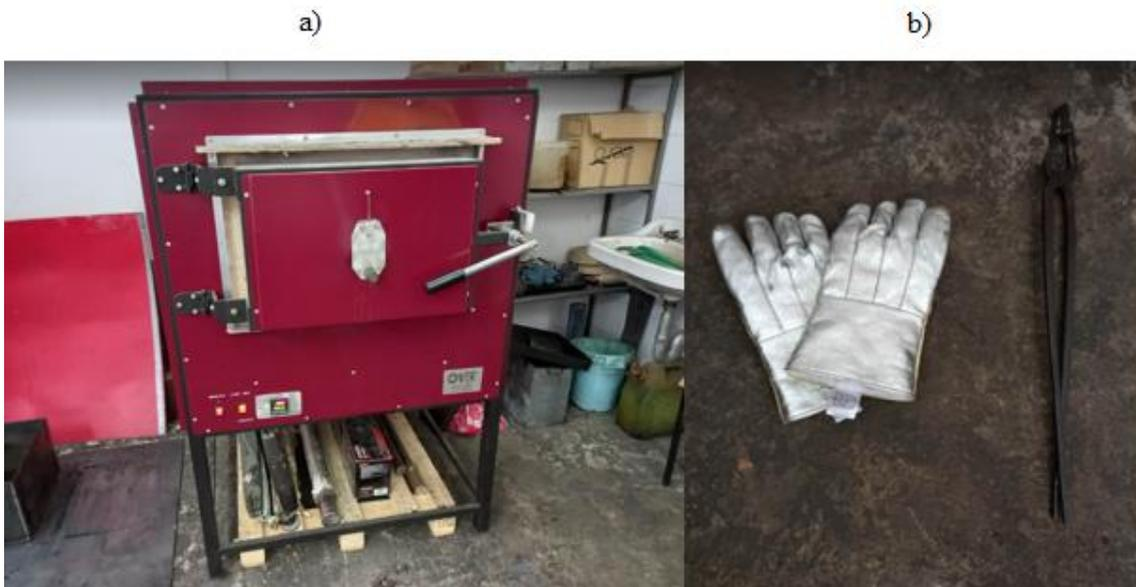
*Slika 7.3. a) Peć za toplinsku obradu;; b) Oprema*
