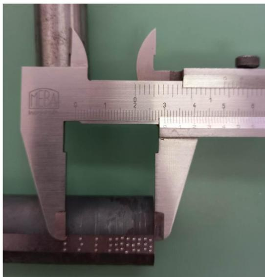
*Slika 7.12. Provjera udaljenosti od gašenog čela Jominyjevog uzorka*
