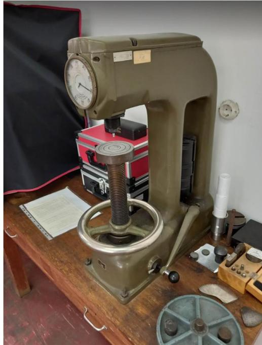
*Slika 7.9. Tvrdomjer za ispitivanje tvrdoće Rockwellovom metodom*
