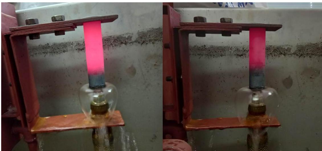
*Slika 7.6. Stanje uzorka nakon 1 minute i 2 minute gašenja*
