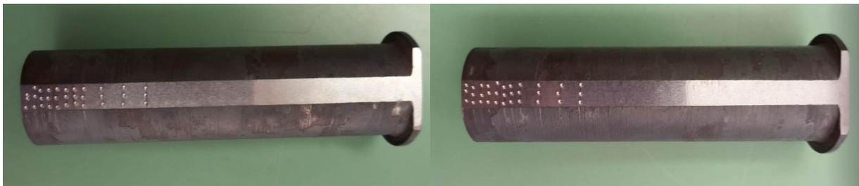
*Slika 7.11. Izgled površina Jominyjevog uzorka po završetku ispitivanja tvrdoće*
