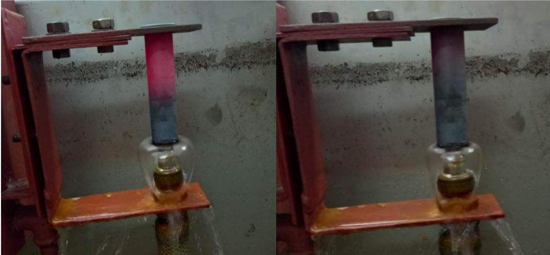
*Slika 7.7. Stanje uzorka nakon 3 minute i 4 minute gašenja*
