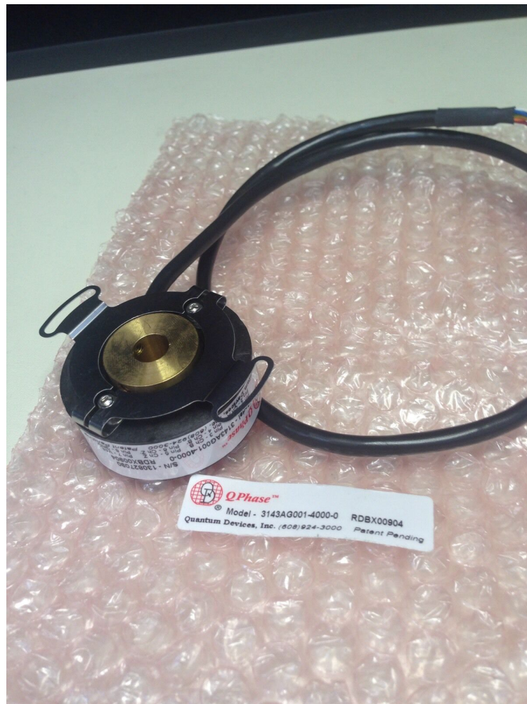
Slika 10.2. Quantum Devices QPhase Optički inkrementalni enkoder
