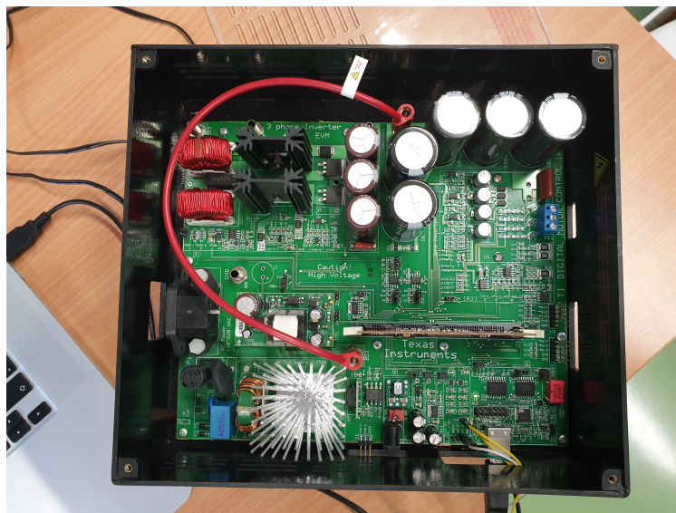
Slika 3.2. Energetska elektronika "HVMotorCtrl+PFCKit-R5"
