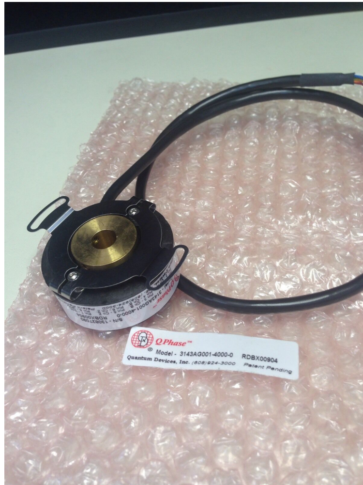
Slika 10.2. Quantum Devices QPhase Optički inkrementalni enkoder
