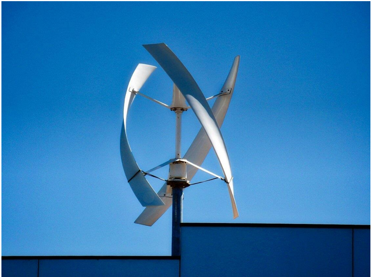
Slika 2.6. Darrieus vjetroturbina sa spiralnim lopaticama
