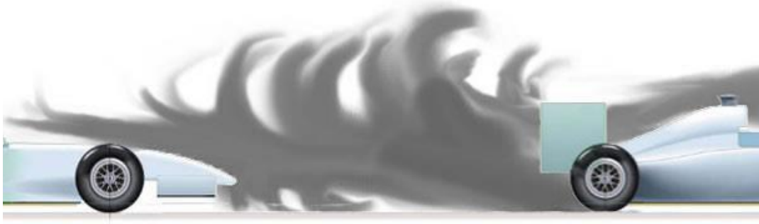
Slika 5.1 Turbulentni zrak iza bolida [28]
