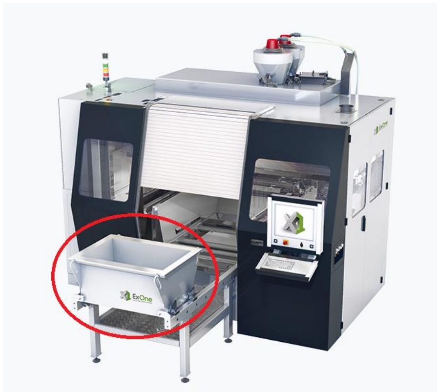
Slika 2.7 Prikaz komore predmeta uređaja ExOne S-Print [2]
