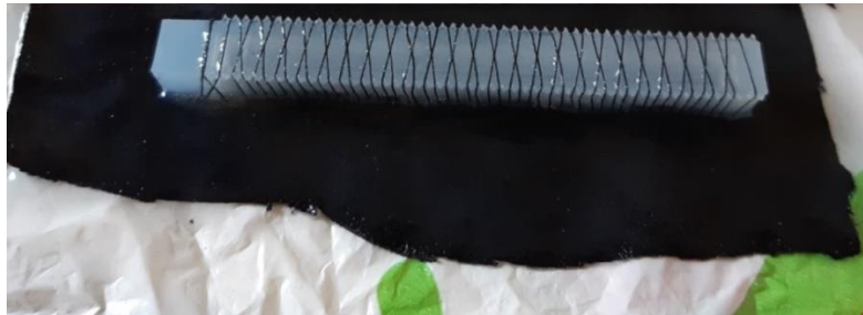
Slika 5.16. Lijepljenje pamučne tkanine na prototip B
