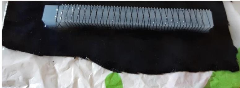
*Slika 5.16. Lijepljenje pamučne tkanine na prototip B*
