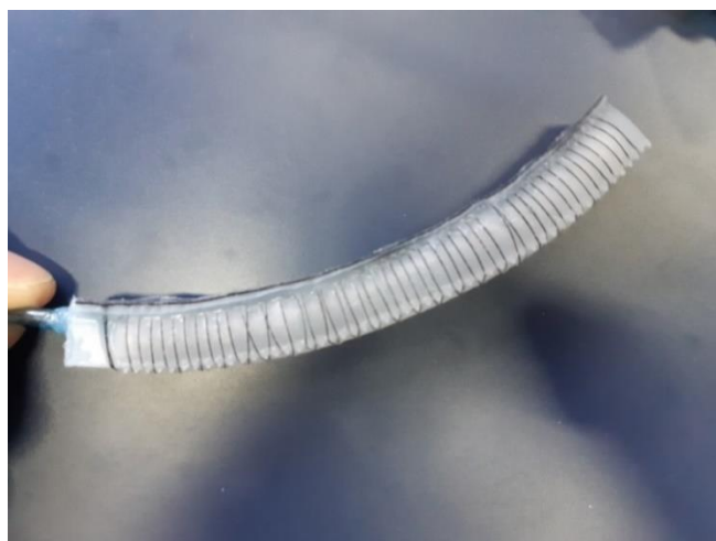
Slika 6.5. Prototip B pri tlaku od 1 bar
