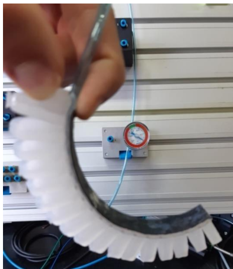
Slika 6.1. Ispitivanje prototipa A pri 0.2 bara
