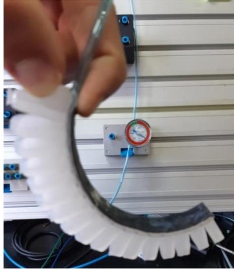
*Slika 6.1. Ispitivanje prototipa A pri 0.2 bara*
