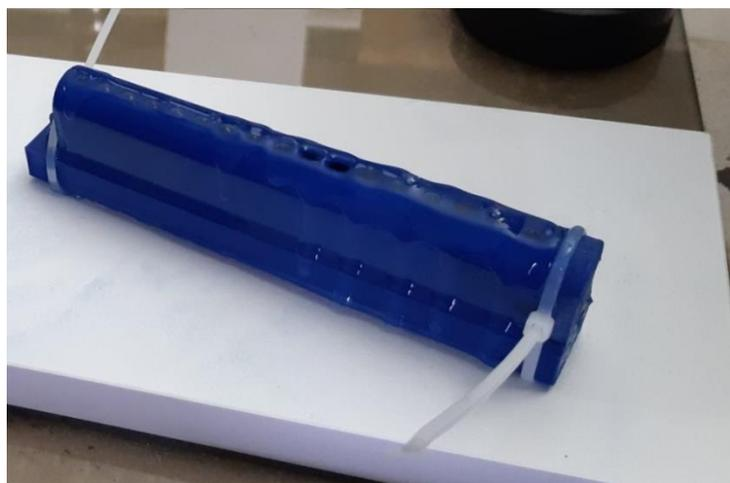
*Slika 5.5. Lijevanje silikona u kalupe (Prototip A)*
