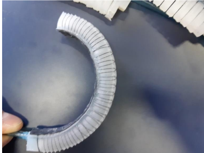
Slika 6.6. Prototip B pri tlaku od 2 bara
