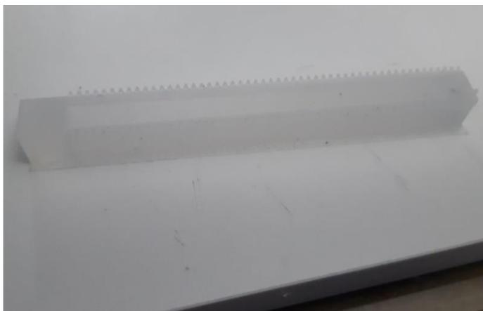
*Slika 5.14. Izgled prototipa B nakon rastavljanja kalupa*
