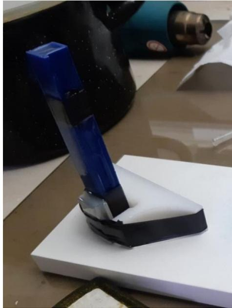
*Slika 5.13. Lijevanje silikona u kalupe (Prototip B)*
