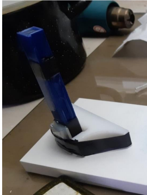
Slika 5.13. Lijevanje silikona u kalupe (Prototip B)
