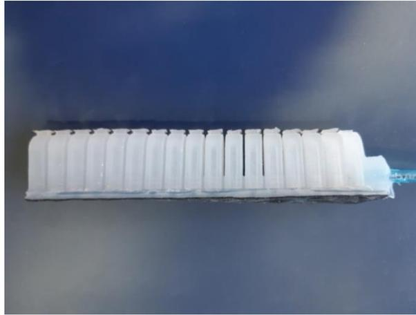
*Slika 5.8. Konačni izgled mekog robota prototipa A*
