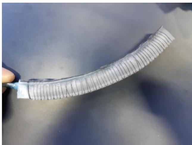
*Slika 6.5. Prototip B pri tlaku od 1 bar*
