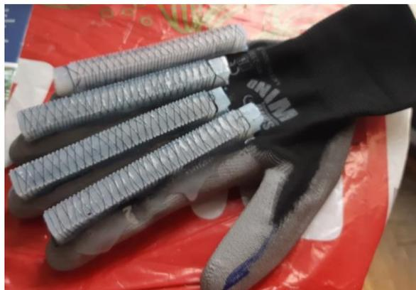
*Slika 8.1. Izrada rukavice za rehabilitaciju šake*
