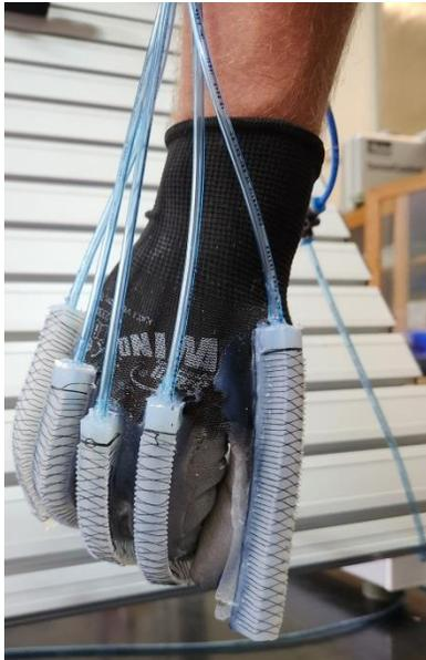
*Slika 8.4. Ispitivanje rukavice: fleksija 4 prsta (bez palca)*
