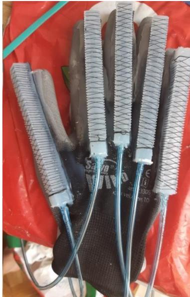
*Slika 8.2. Konačni izgled prototipa rukavice za rehabilitaciju šake*
