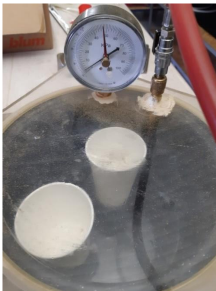
Slika 5.4. Vakuumiranje silikona u čašama
