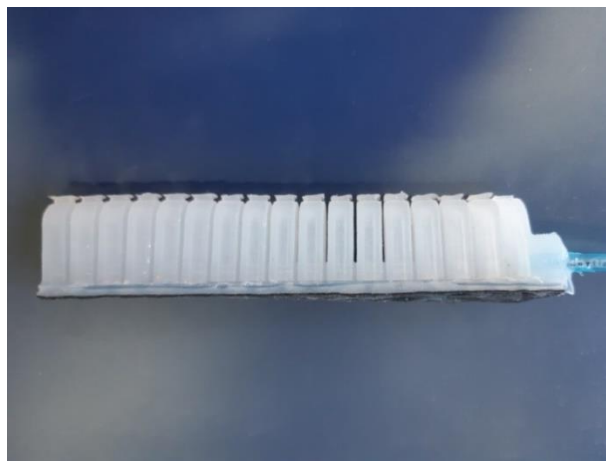
Slika 5.8. Konačni izgled mekog robota prototipa A
