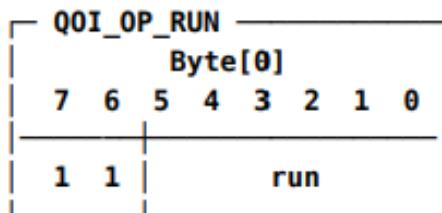
Slika 2.2 Blok bitova koji se zapisuje u 1. slučaju, preuzeto iz [9]
