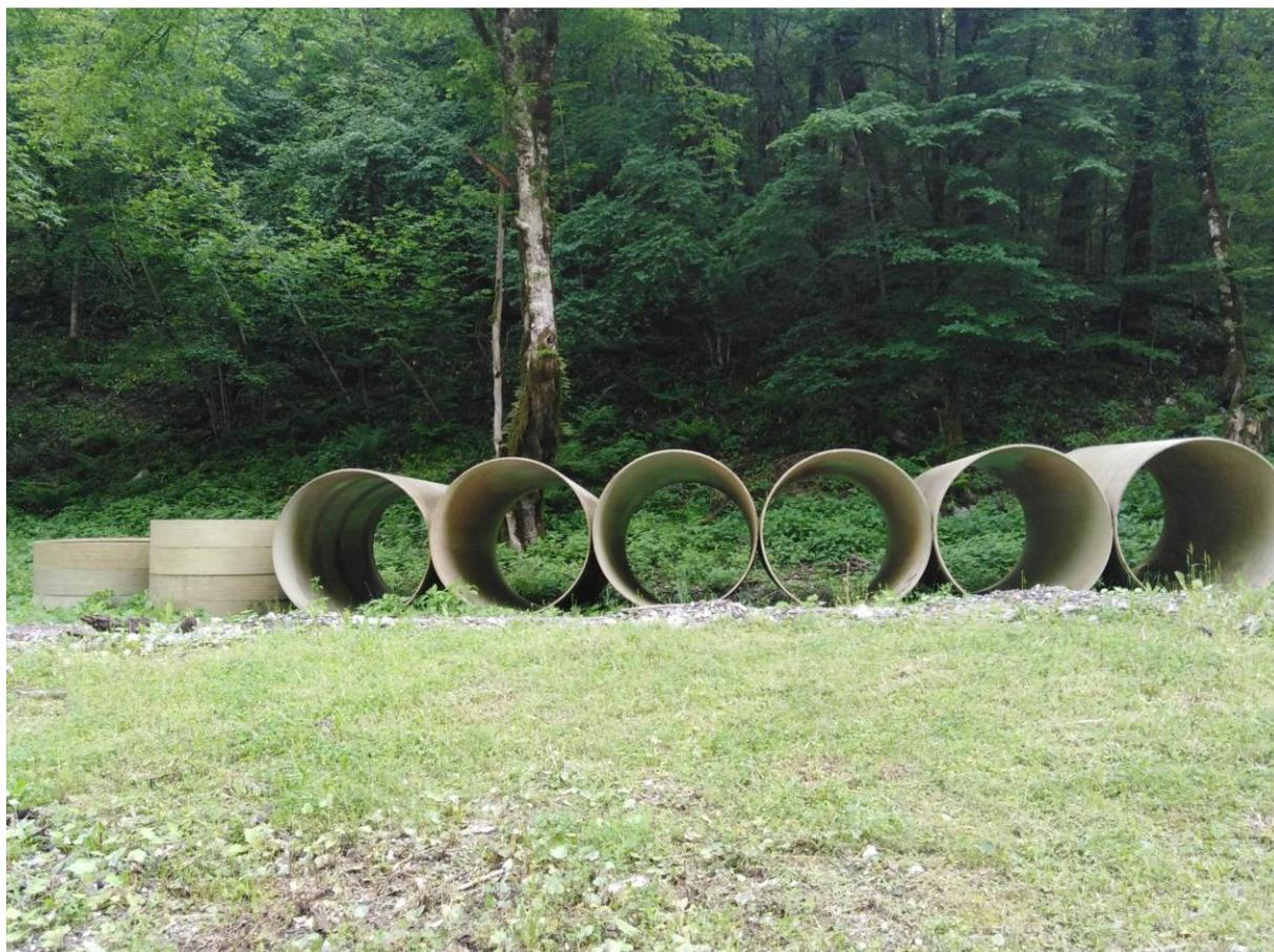
Slika 5. 2. Dijelovi cjevovoda HE Curak
