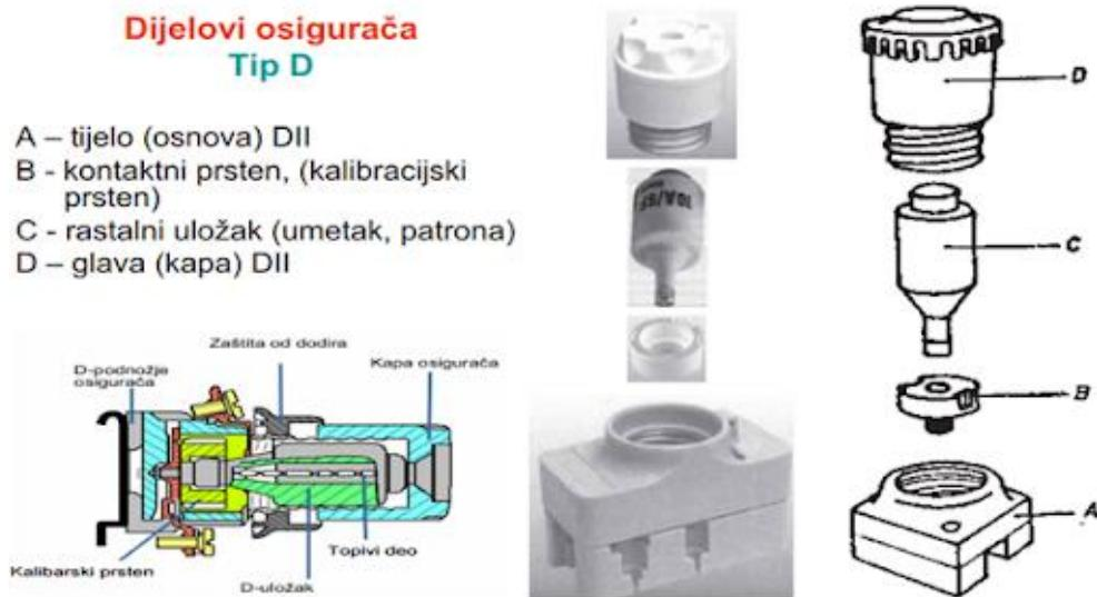
Slika 3.4. Dijelovi osigurača D tipa [4]
