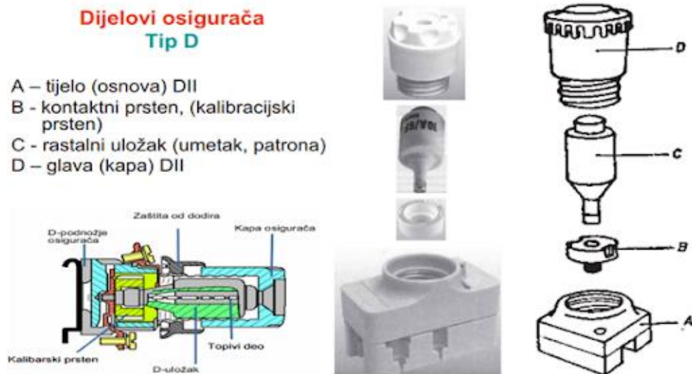
Slika 3.4. Dijelovi osigurača D tipa [4]
