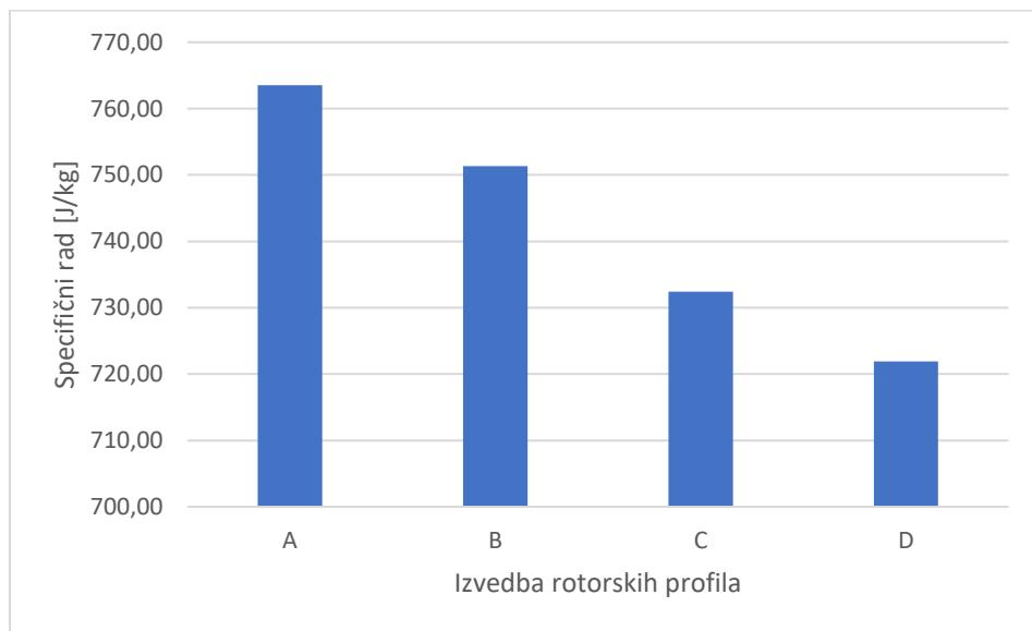
Slika 60: Specifičan rad ostvaren na testiranim rotorskim kaskadama
