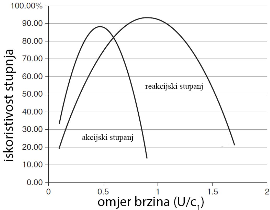
Slika 19: Usporedba stupnjeva korisnosti akcijskog i reakcijskog stupnja s obzirom na omjer obodne i ulazne
