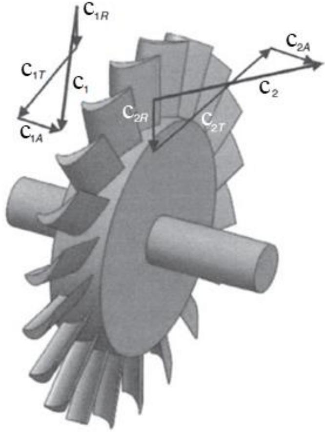
Slika 10: Aksijalni turbinski rotor sa prikazom komponenata brzina
