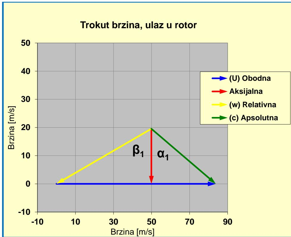
Slika 38: Trokut brzina na ulasku u rotor
