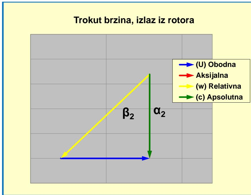
Slika 40: Shematski prikaz idealnog izlaznog trokuta brzina
