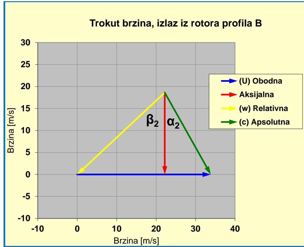
Slika 49: Izlazni trokut brzina za rotorski profil B
