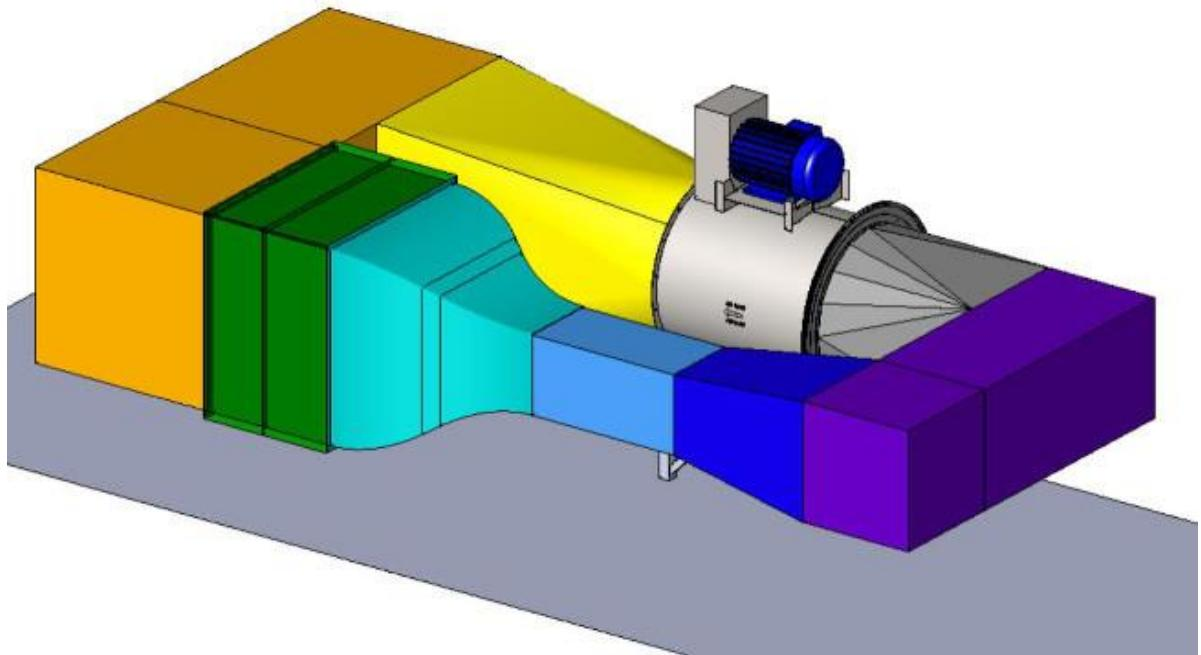
Slika 30: Zatvoren zračni tunel
