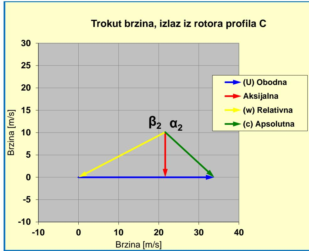
Slika 53: Izlazni trokut brzina za rotorski profil C
