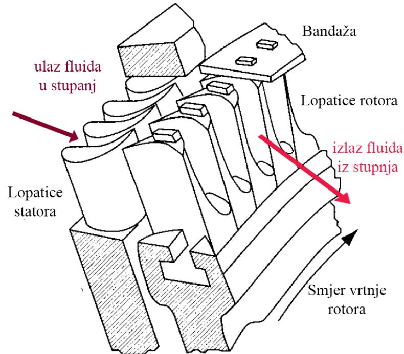
Slika 9: Stupanj turbine sa smjerom strujanja fluida
