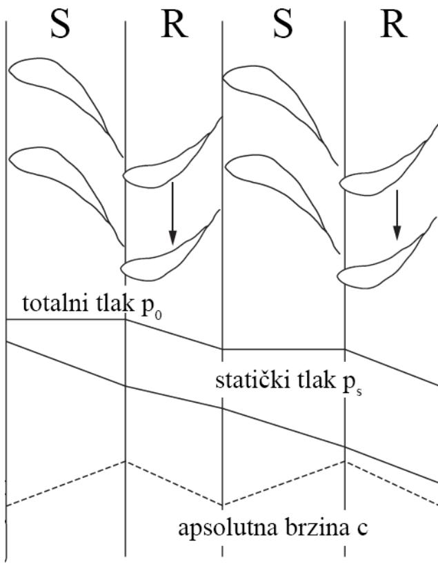
Slika 17: Promjena tlaka i absolutne brzine kroz dva reakcijska stupnja turbine
