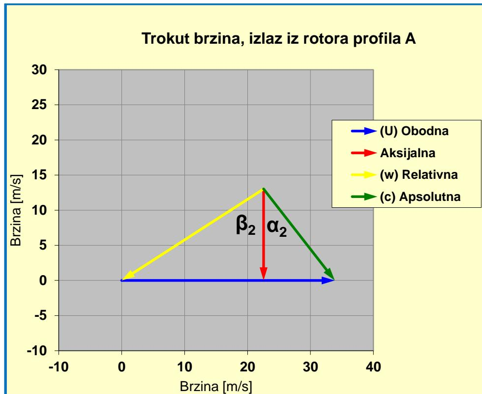
Slika 44: Izlazni trokut brzina za rotorski profil A
