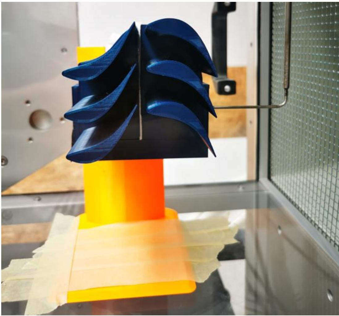
Slika 52: Isprintani model stupnja sa rotorskim profilima tipa C u aerotunelu
