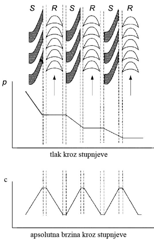
Slika 13: Promjena tlaka i absolutne brzine kroz više akcijskih stupnjeva turbine
