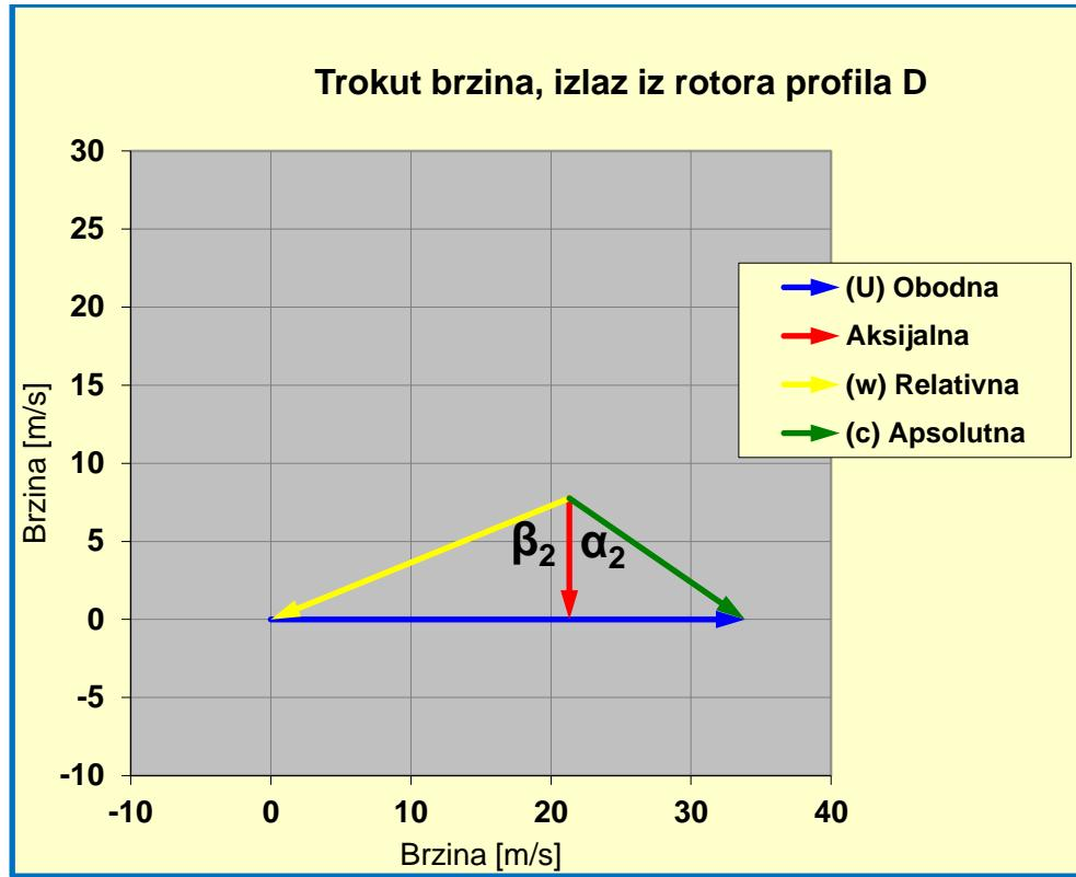
Slika 57: Izlazni trokut brzina za rotorski profil C
