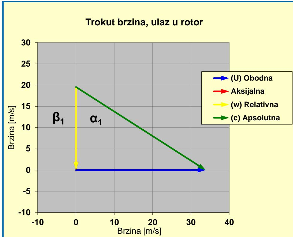
Slika 39: Ulagani trokut brzina u rotor sa modificiranim intenzitetom obodne brzine (druga iteracija ulaznog trokuta)
