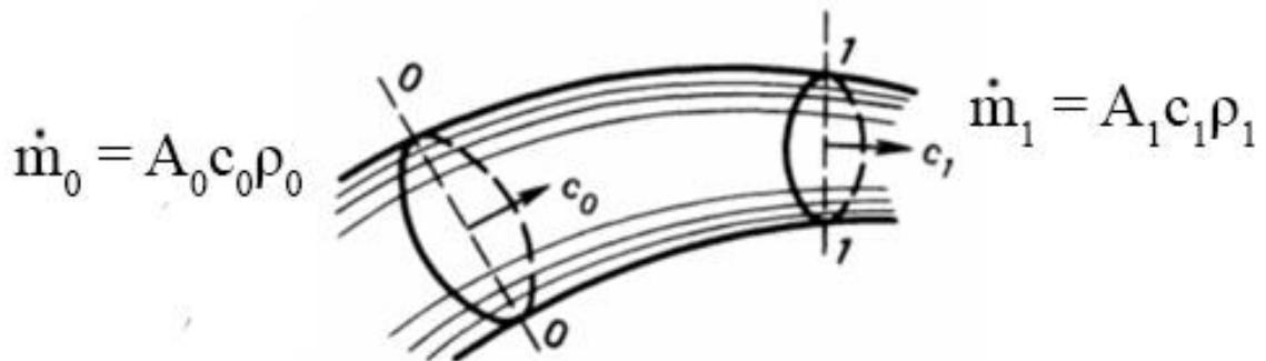
Slika 2: Shema strujne cijevi kroz koju struji fluid
