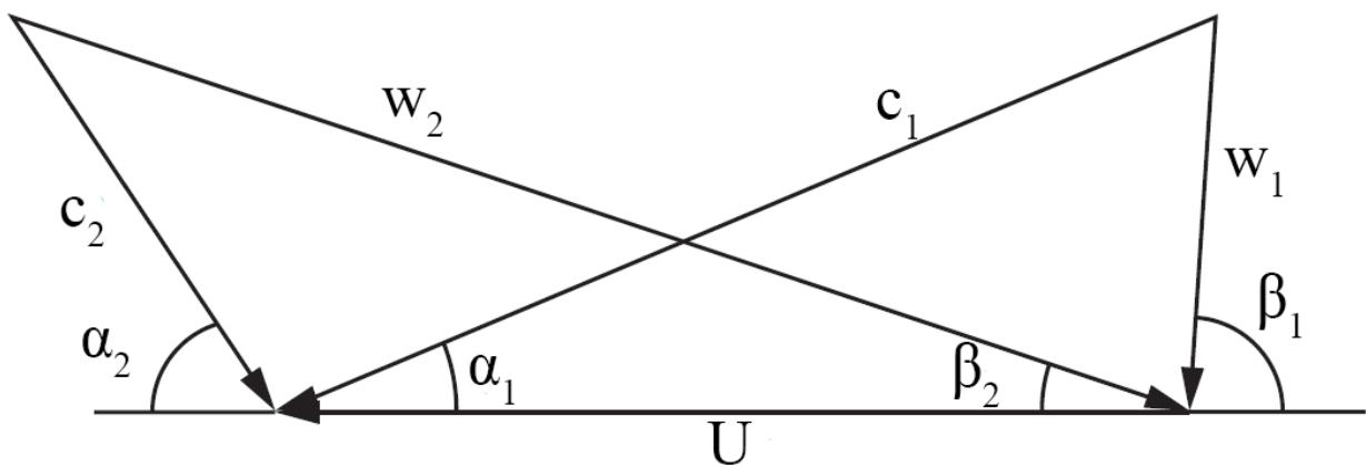
Slika 16: Usporedba ulaznih i izlaznih trokuta brzina na rotoru reakcijskog stupnja
