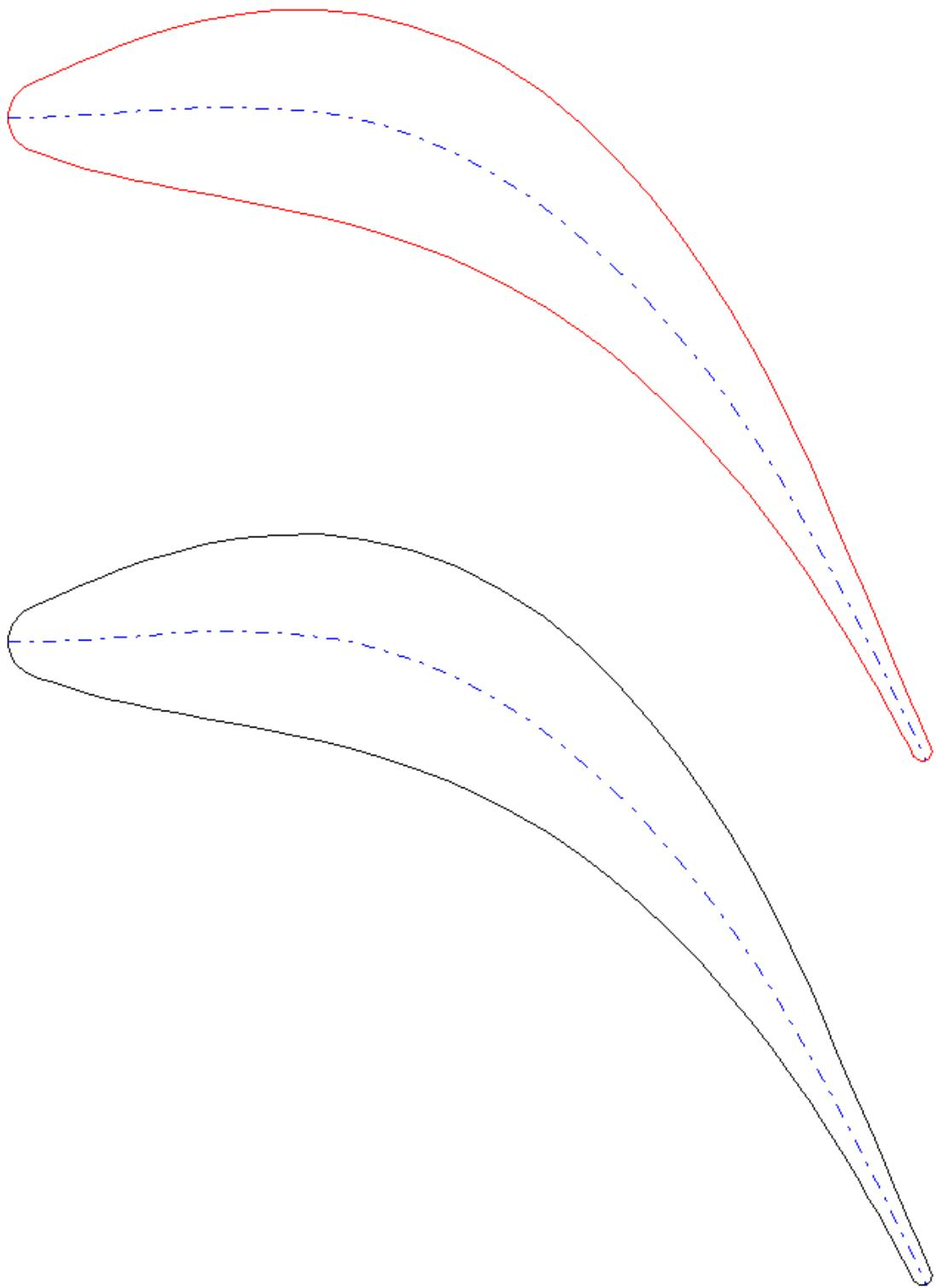
Slika 51: Kaskada rotora s lopaticama profila C
