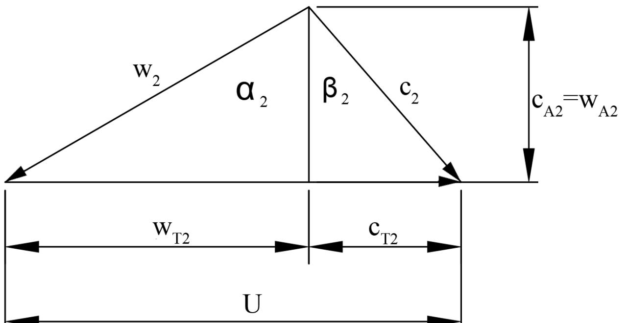
Slika 45: Komponente izlaznog trokuta brzina
