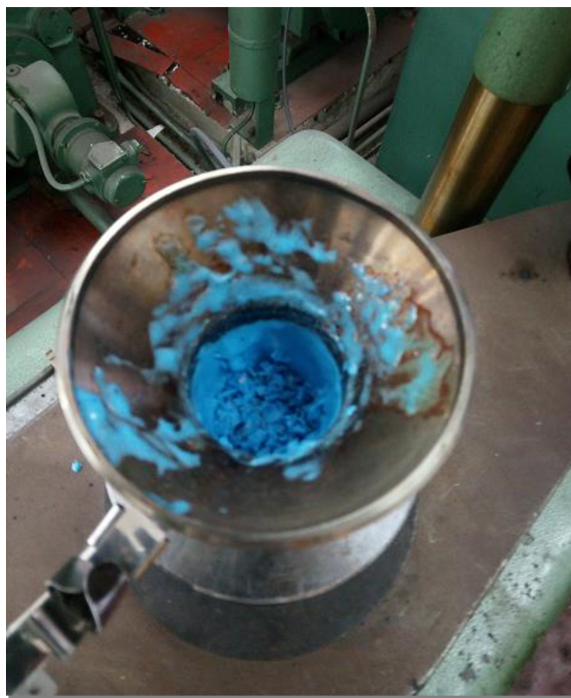
Slika 3.2. Nerastaljeni polimer unutar komore
