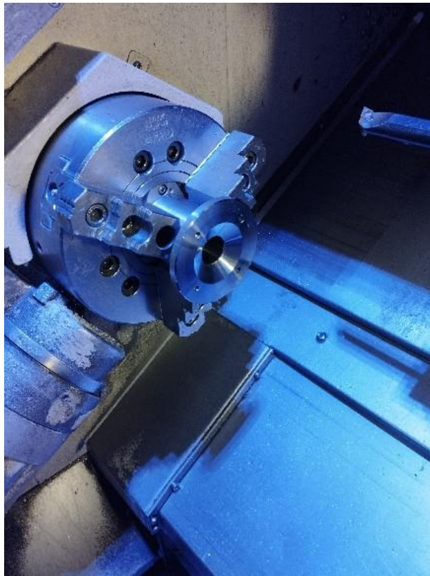
Slika 4.5. Izrada kućišta uređaja na tokarilici
