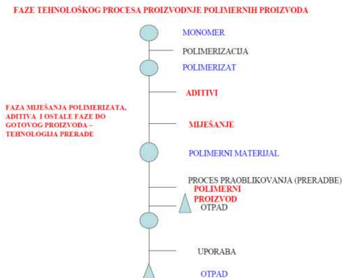
Slika 2.2. Faze tehnološkog procesa proizvodnje polimernih proizvoda [2]
