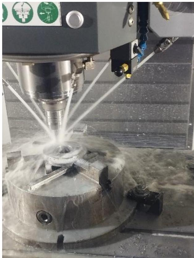
*Slika 4.6. Izrada matice za temperaturnu sondu*
