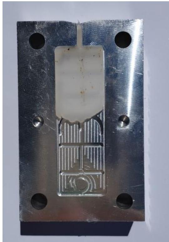
*Slika 6.3. Izgled nakon otvaranja kalupa (TEST 4)*
