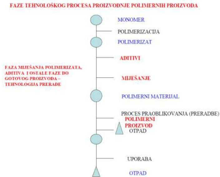
Slika 2.2. Faze tehnološkog procesa proizvodnje polimernih proizvoda [2]
