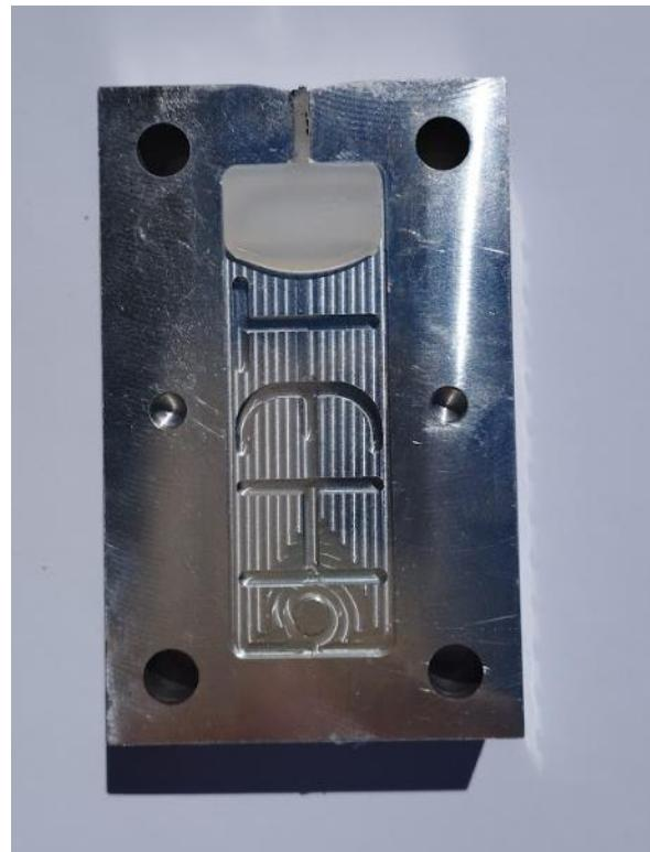
*Slika 6.2. Izgled nakon otvaranja kalupa (TEST 3)*
