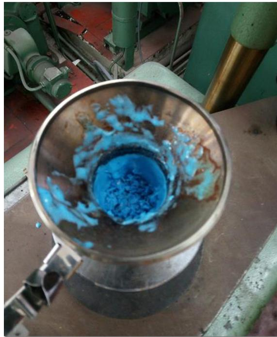
*Slika 3.2. Nerastaljeni polimer unutar komore*
