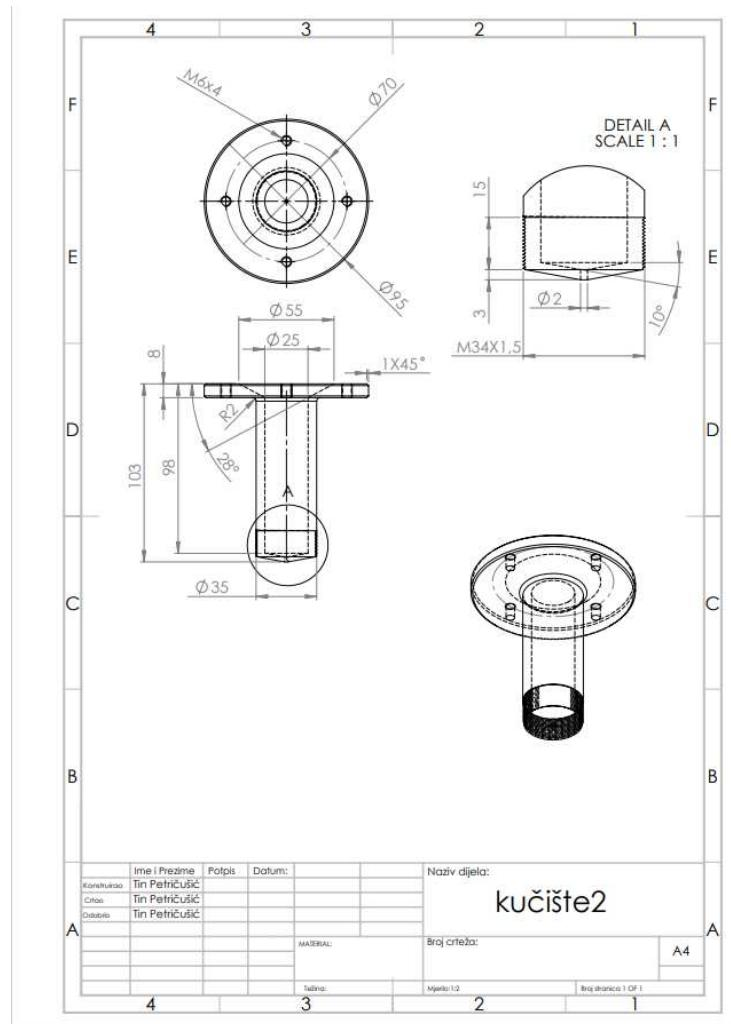
*Slika 4.1. Nacrt kućišta uređaja*
