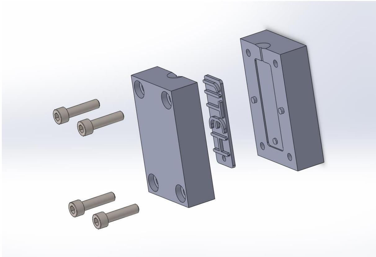
Slika 3.28. CAD-model kalupa
