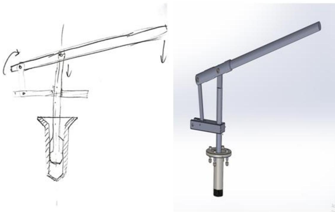
Slika 3.25. Sklop za istiskivanje taljevine (skica i CAD-model)
