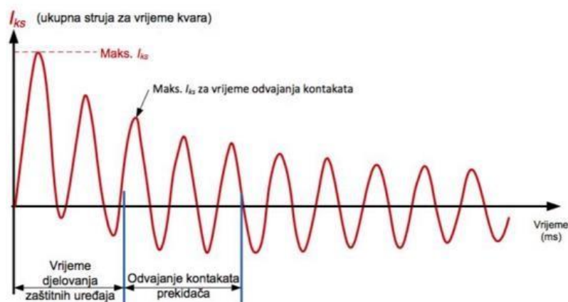
Slika 2.6. Rasklopna struja kratkog spoja
