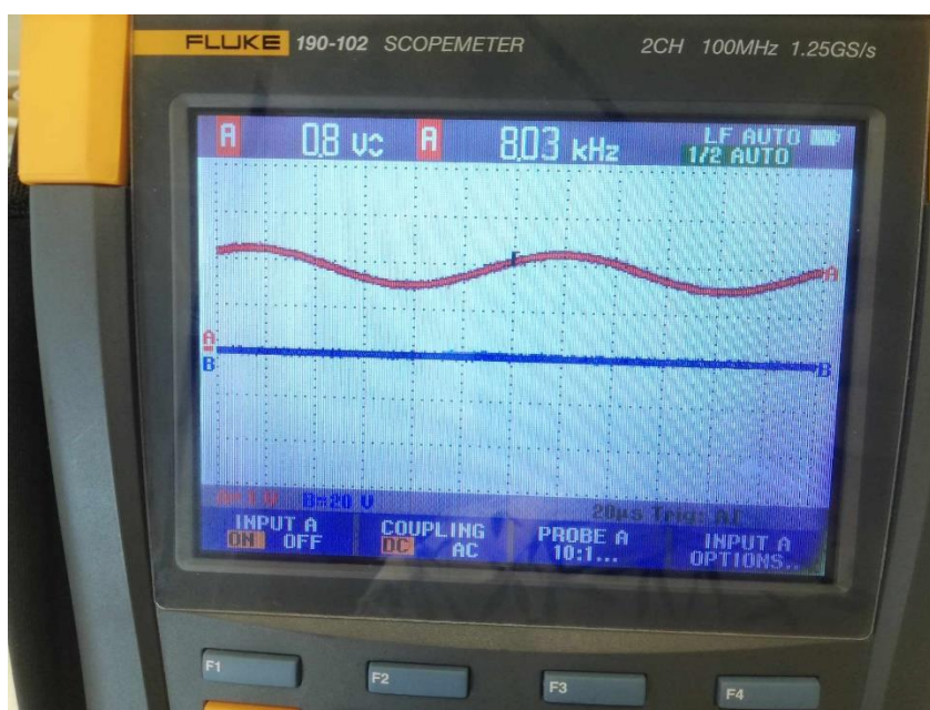
Slika 5.14 Izlaz iz pojačala kod prevelike struje
