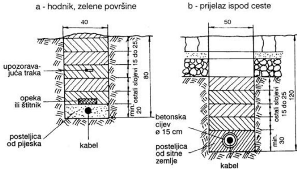
Slika 6.2: Standardni način polaganja kabela izravno u zemlju [6]
