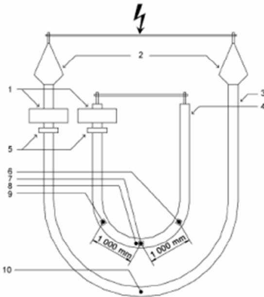
*Slika 4.1: Ispitna petlja za tipsko ispitivanje kabela i kabelskog pribora [1]*
