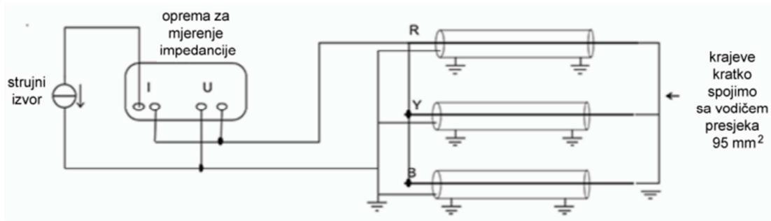
Slika 6.14: Shema postupka ispitivanja impedancije nultog slijeda [13]
