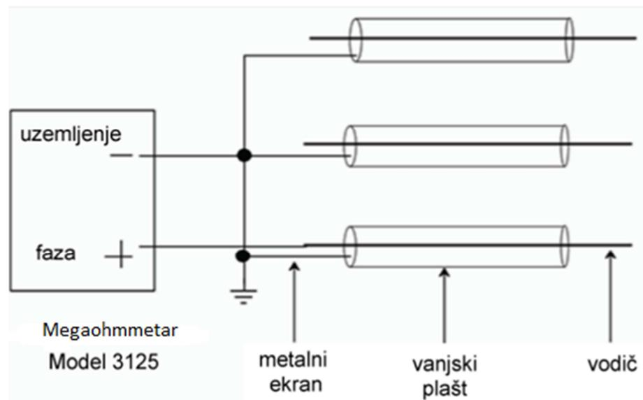
Slika 6.12: Shema postupka ispitivanja otpora izolacije [13]
