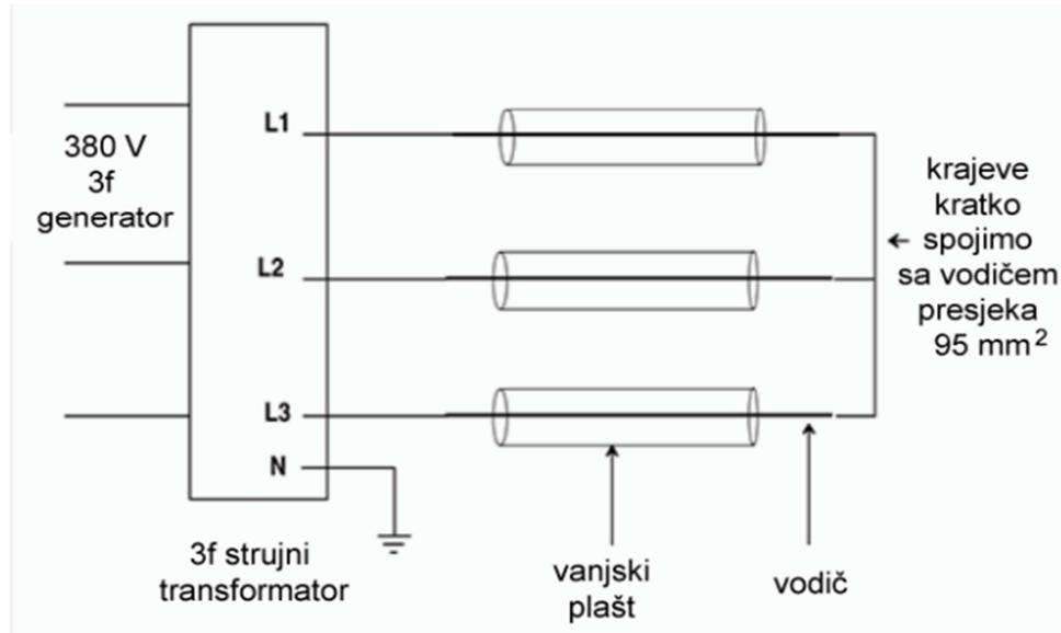
Slika 6.13: Shema postupka ispitivanja poprečnog spajanja [13]
