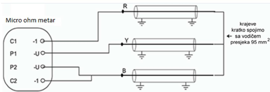
Slika 6.5: Shema mjerenja otpora vodiča [7]
