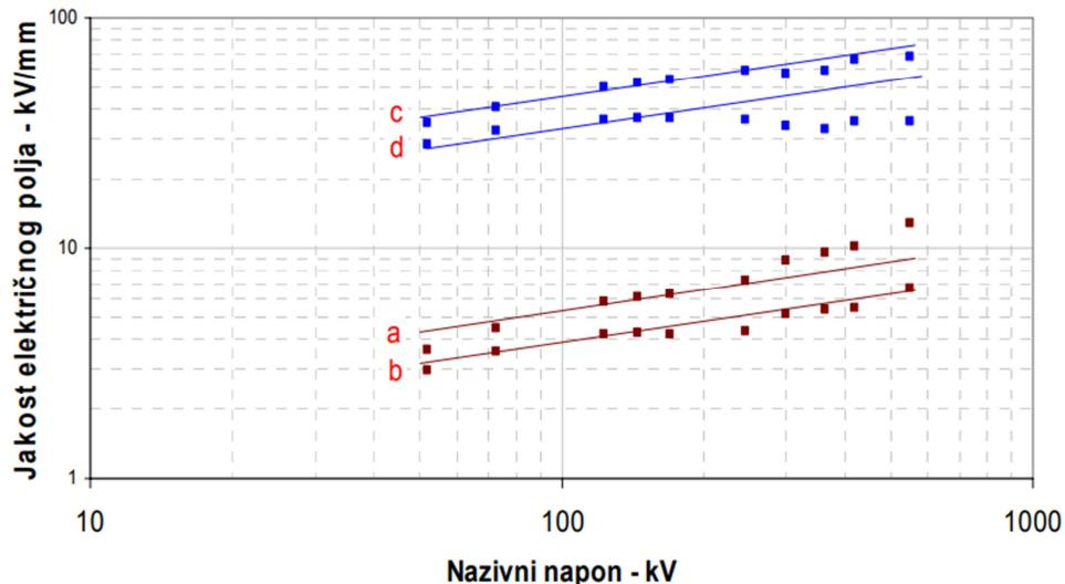
Slika 2.5: Jakost električnog polja koji se nalazi unutar visokonaponskih energetskih kabela [1]
