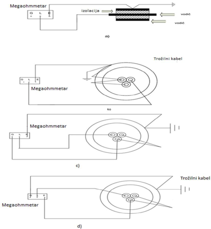
Slika 6.11: Postupak spajanja kabela za mjerjenje otpora izolacije [12]
