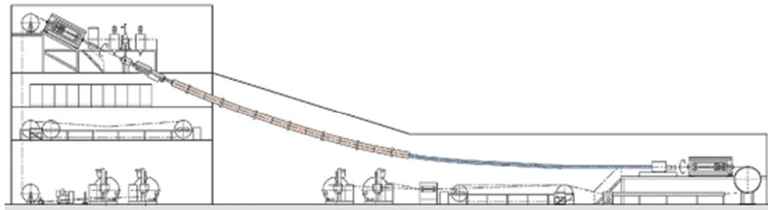
*Slika 2.2: Shematski prikaz linije za izoliranje visokonaponskog kabela [2]*
