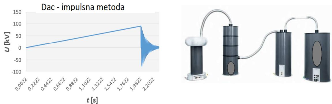
Slika 5.7: ACRF rezonantni sustav snage promjenjive frekvencije [5]
