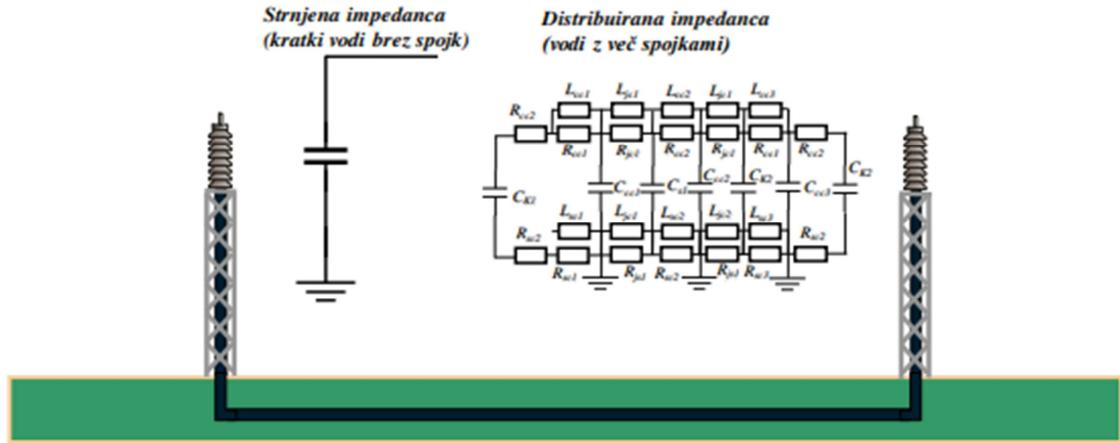
Slika 5.3: Prikaz VN kabela s distribuiranom impedancijama [5]
