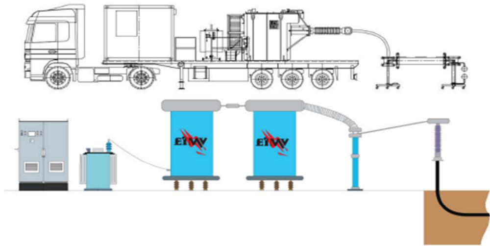
Slika 5.6: ACRF rezonantni sustav snage promjenjive frekvencije [5]
