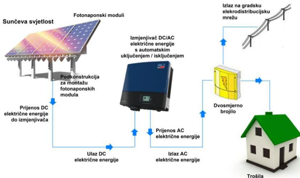
Slika 9 Shema aktivnog mrežnog fotonaponskog sustava tzv. prosumera
