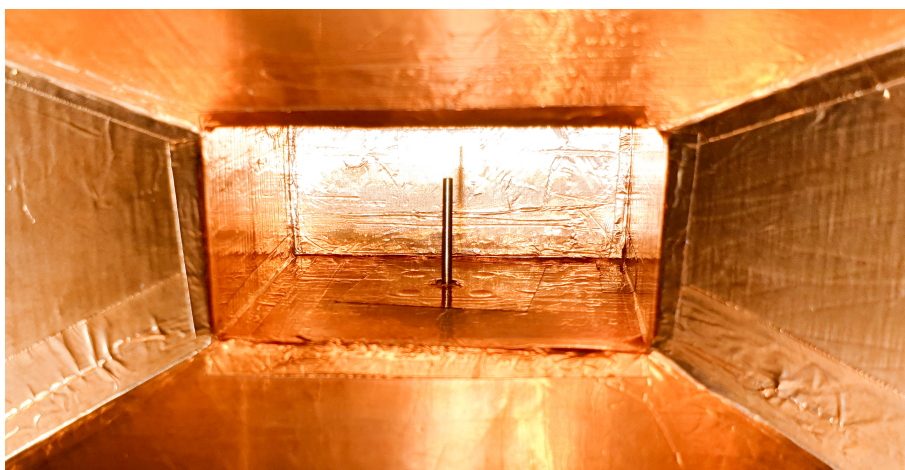
Slika 4.16 Proizvedena pobudna sonda u lijevak anteni.
