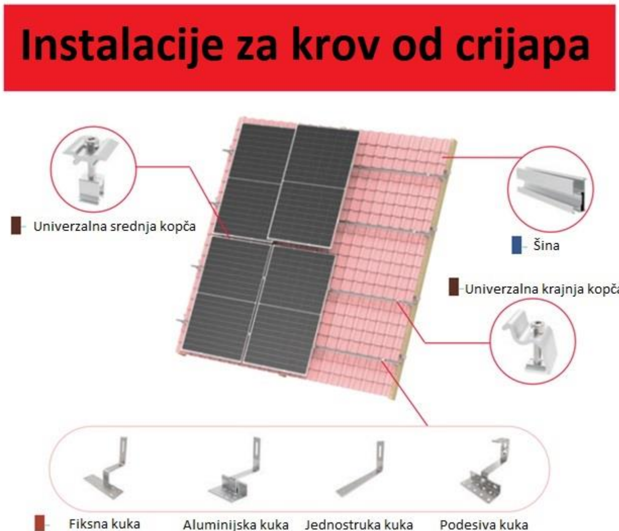
Slika 10.5. Konstrukcija nosača iz kataloga [34]
